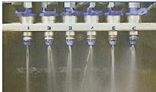
Fig. 5.26. Ejemplo de un mal funcionamiento inyectores
