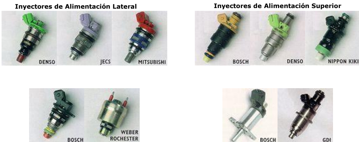
Fig. 5.25. Tipos de inyectores según el punto de alimentación de combustible
