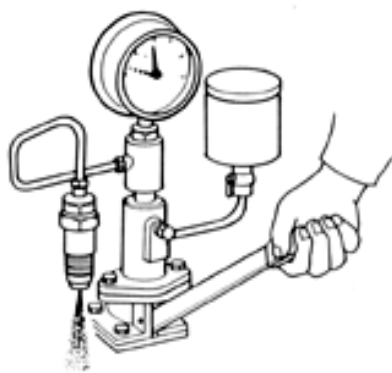
Fig. 5.31. Prueba de presión de apertura
