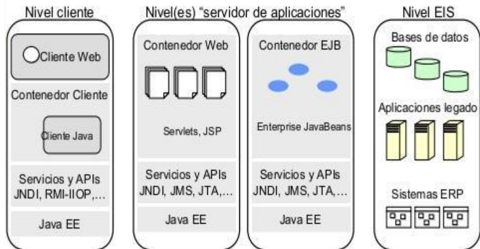
Figura 14: Arquitectura Java Enterprise Edition. Fuente: (Pickin & et al, 2010).
