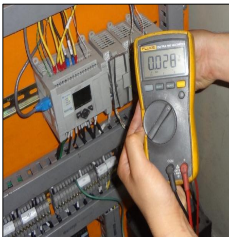
Figura 4. 10: Medición del voltaje que llega de la termocupla.
