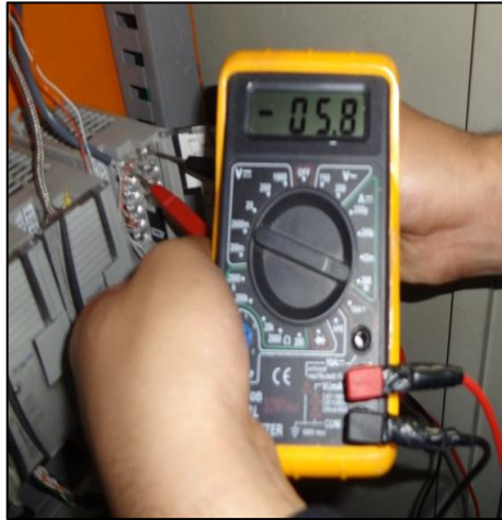
Figura 4. 11: Medición de la señal de corriente del transmisor de presión
