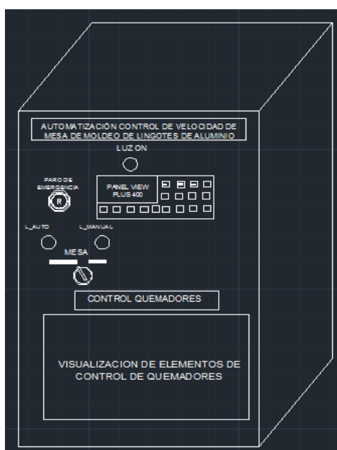
Figura 2. 18: Distribución externa el tablero de control.
