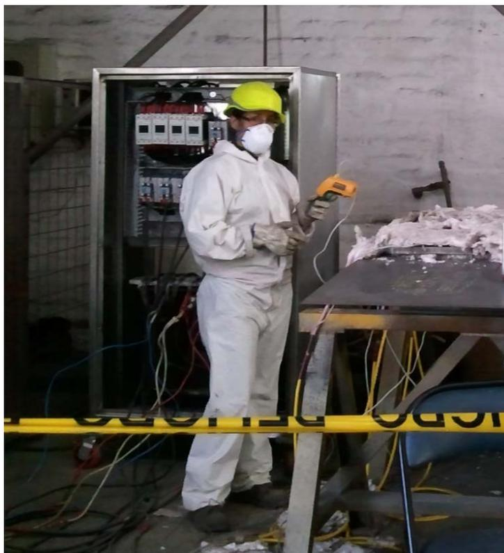
Figura. 97. Toma de datos con Pirómetro.
