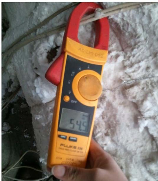
Figura. 19. Toma de datos con pinza amperimétrica.
