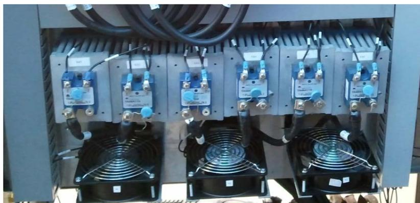
Figura. 61. Relés, Disipadores y Ventiladores instalados
