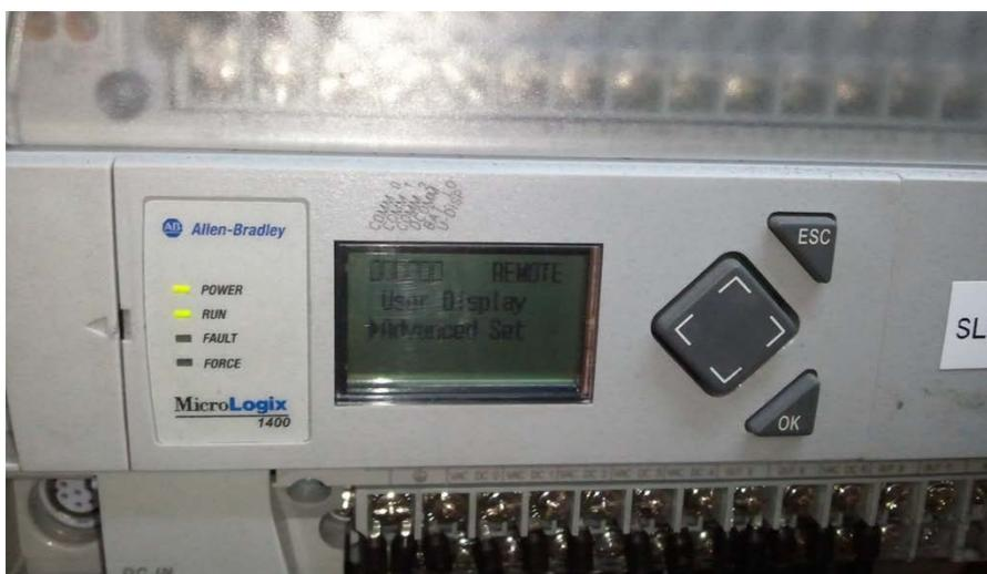
Figura. 90. Panel de control del PLC.
