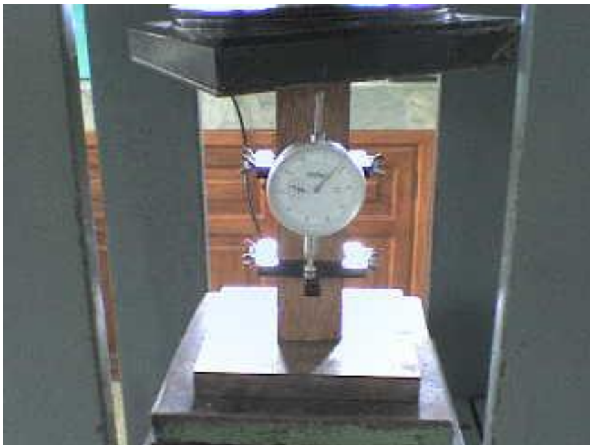
Figura 5.3 Compresión axial o paralela al grano en madera.
