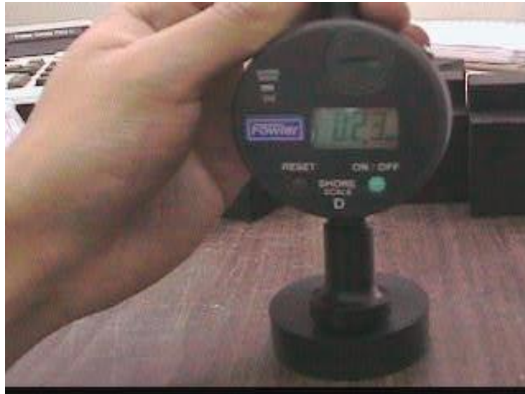
Figura 3.6 Ensayo de dureza para caucho
