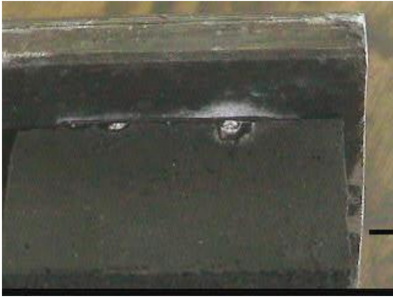
Figura 3.22 Ensayo a una junta de acero y caucho
