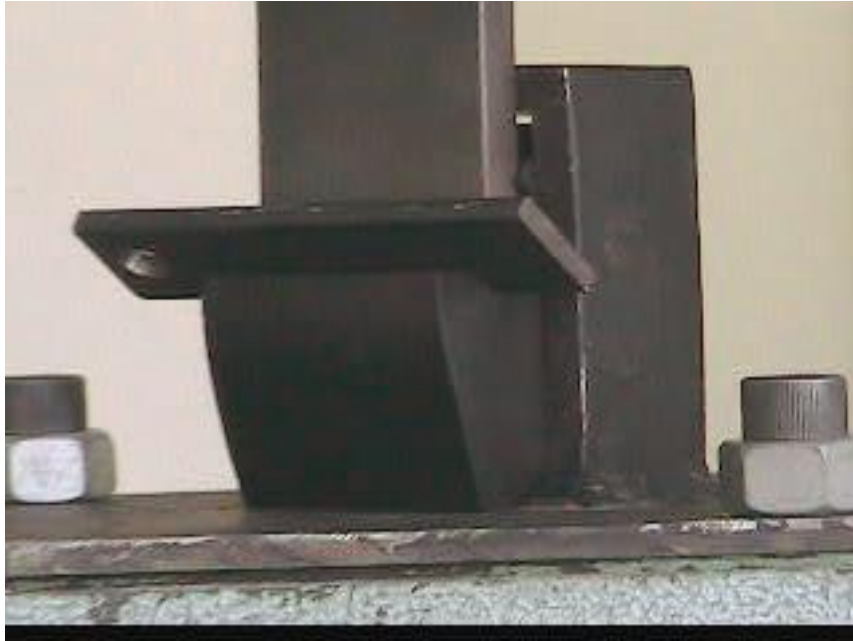
Figura 3.17 Ensayo de corte directo en caucho.
