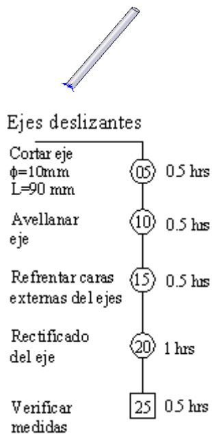
Figura 4.8 Diagrama de operación para ejes deslizantes
