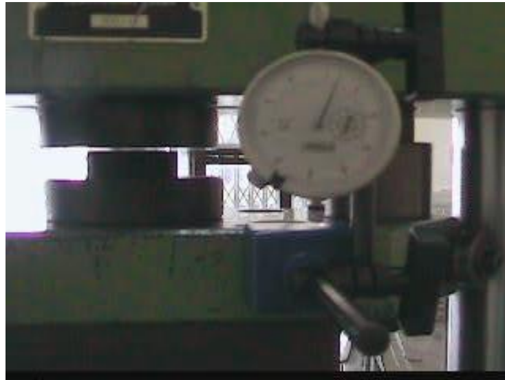
Figura 3.7 Ensayo de compresión para caucho
