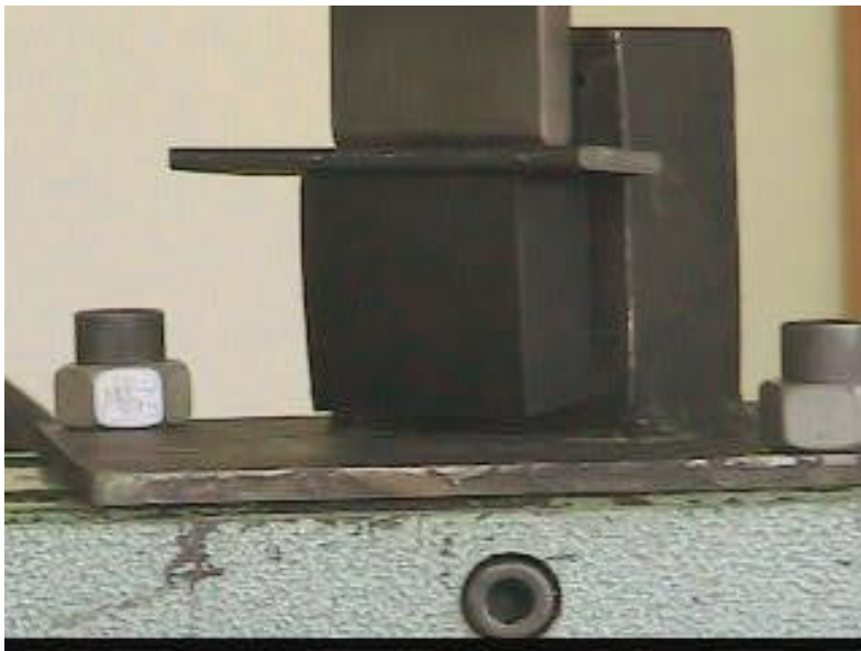
Figura 3.20 Ensayo de corte directo en probeta conformada por caucho y acero
