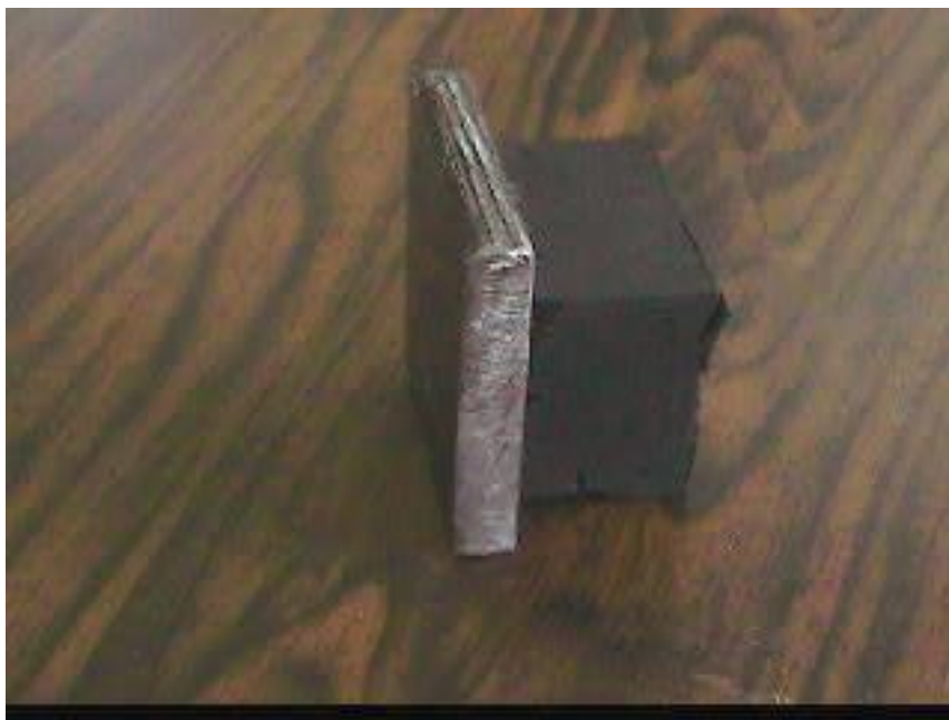
Figura 3.12 Probeta conformada por placa de acero y prisma de caucho
