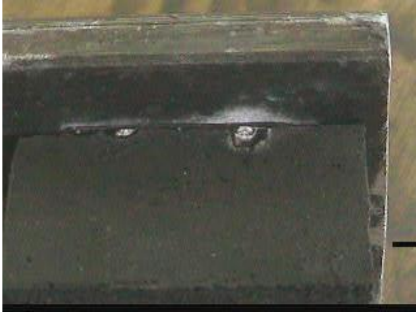
Figura 3.15 Probeta de acero y caucho adherido mediante loctite 454.
