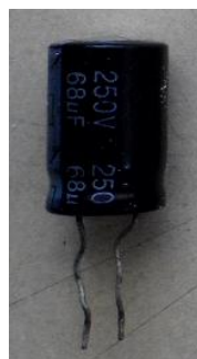
Figura3.6: Capacitor electrolítico 68uF a 200V
