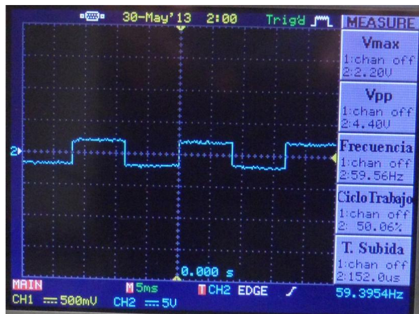
Figura 5.44: Valor del voltaje de salida y corriente controlada
