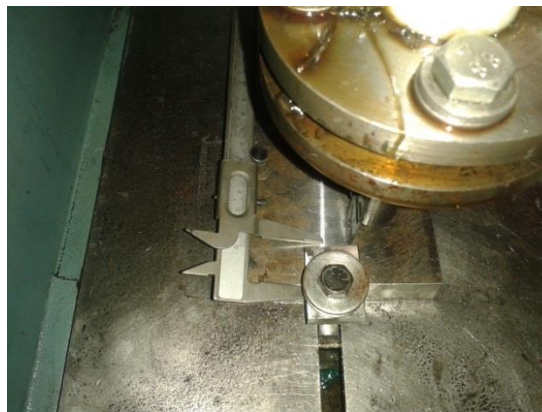
Figura 4-7 Verificación delo desplazamiento de la mesa de trabajo eje X.
