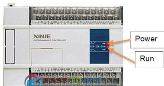
Figura 4-2 Verificación del encendido del PLC.
