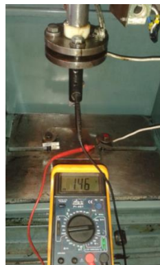
Figura 4-5 Verificación del voltaje de la fuente de alimentación.
