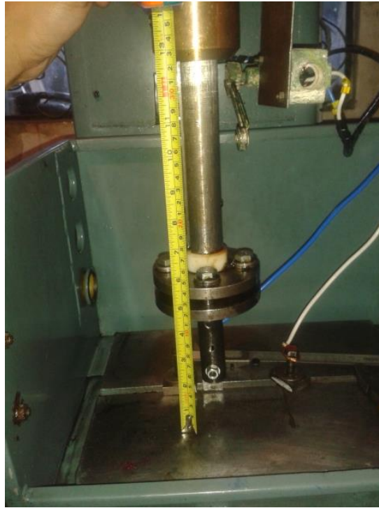
Figura 4-8 Verificación del desplazamiento del eje Z.
