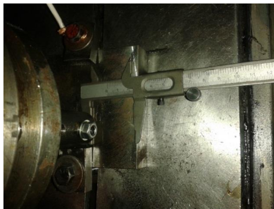
Figura 4-6 Verificación del desplazamiento de la mesa de trabajo eje Y.
