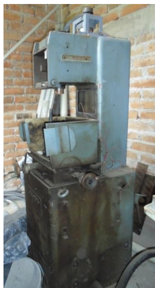
Figura 2-1 Máquina electroerosionadora: condiciones iniciales.
