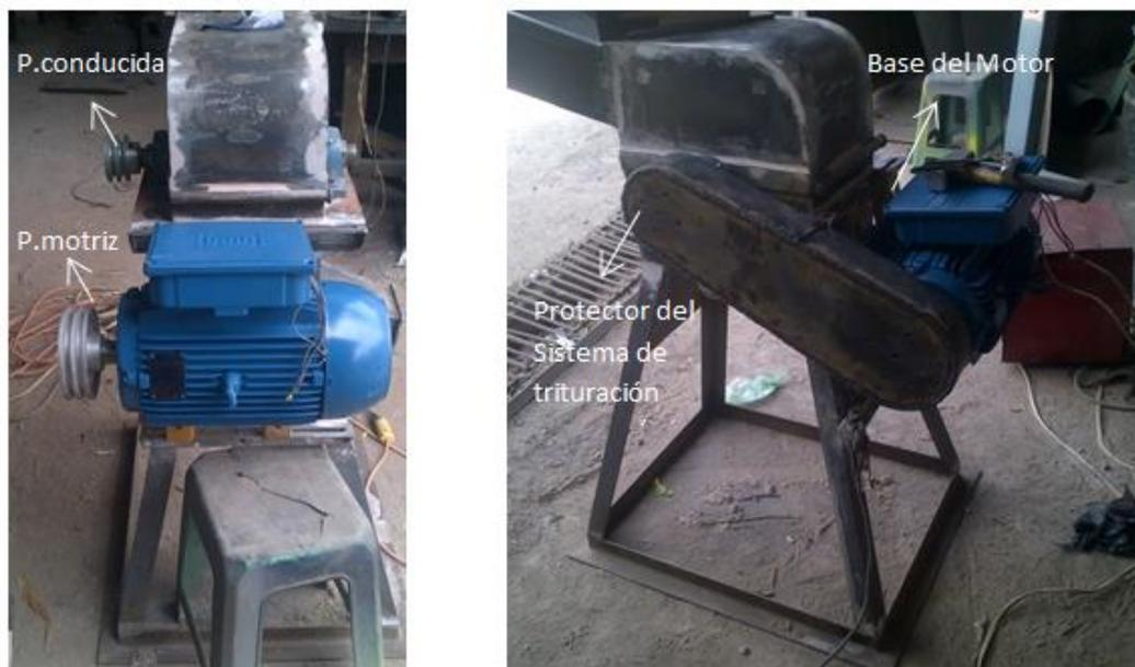
Figura 3.16 Montaje del Sistema de transmisión
