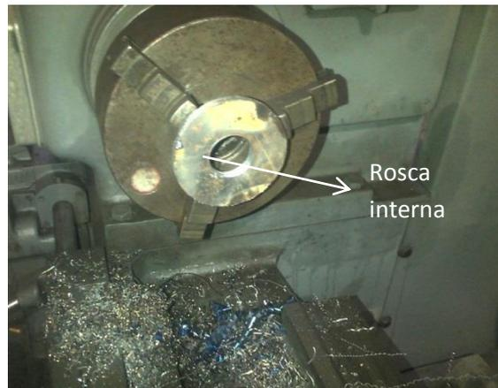
Figura 3.10 Mecanizado de las tuercas
