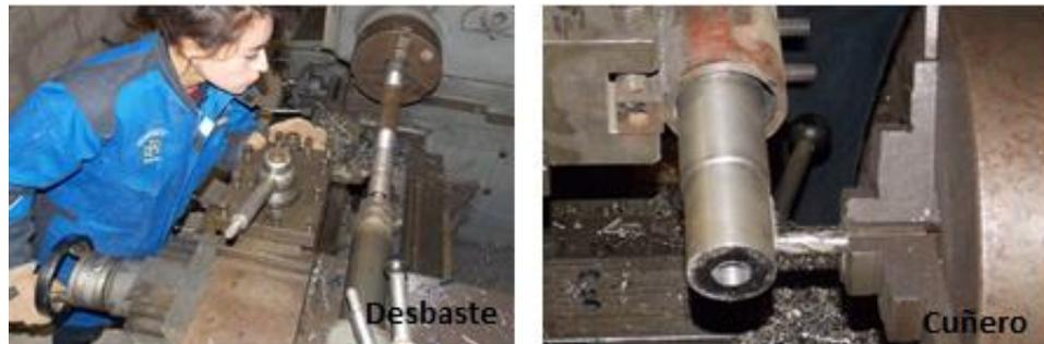
Figura 3.9 Mecanizado del eje principal
