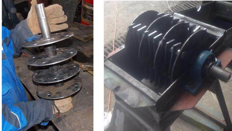
Figura 3.15 Ensamble del sistema de trituración
