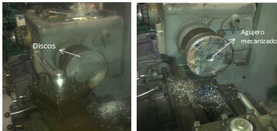
Figura 3.3 Mecanizado de los discos en el torno
