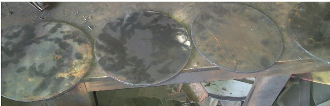
Figura 3.2 Discos cortados equipo de corte por plasma.
