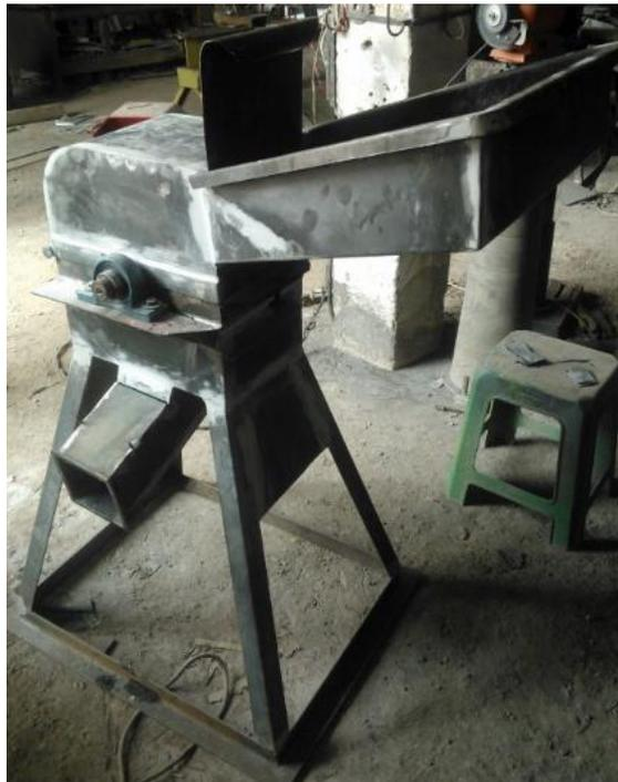
Figura 3.14 Ensamble del armazón del molino
