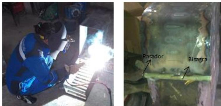
Figura 3.13 Montaje de la tapa del molino y el bastidor
