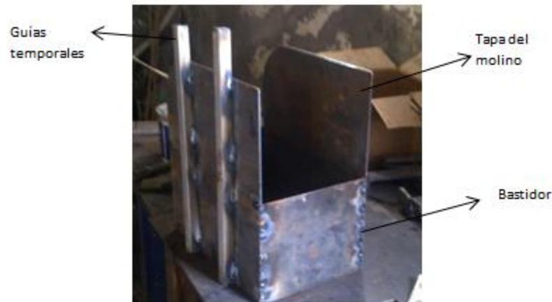
Figura 3.7 Construcción de la tapa del molino
