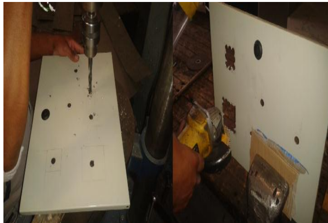
Adaptación de los elementos de control en el tablero
