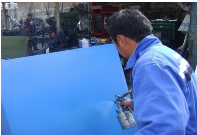
Aplicación de la pintura de acabados.
