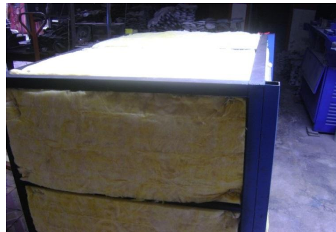
Sujeción de la lana de vidrio.
