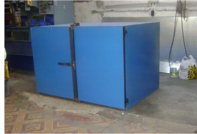
Ensamble de las paredes del horno.
