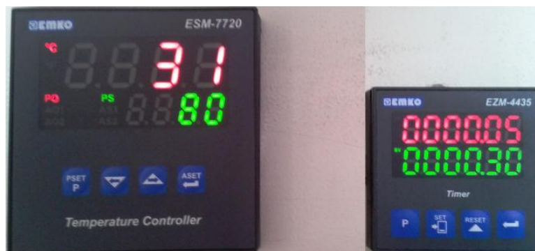
Figura 4. 3: Prueba realizada en el horno. (Aguirre/Sánchez, Medicion de temoeratura con el controlador de temperatura 2014)
