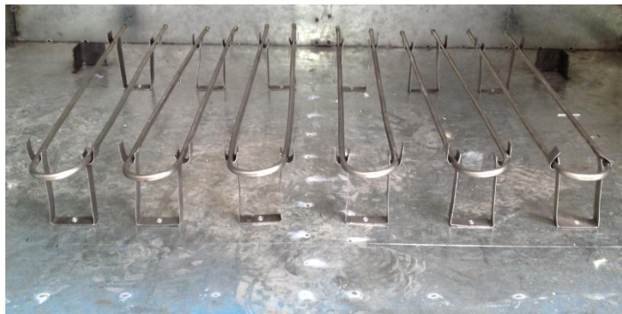
Figura 3. 8: Instalación de las resistencias eléctricas. (Aguirre/Sánchez, Resistencia Electrica 2013)
