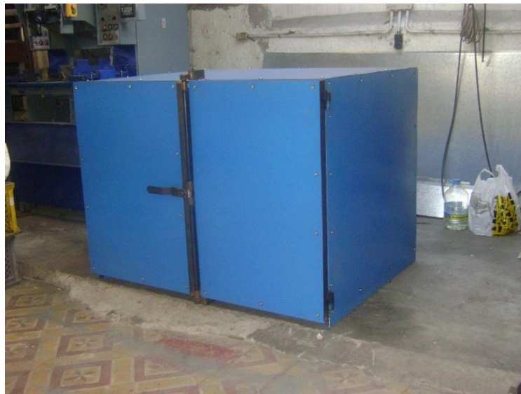
b.- Ensamble de las paredes del horno.
