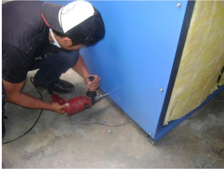
a.- Ensamble mediante tornillo hexagonal autopercorante.
