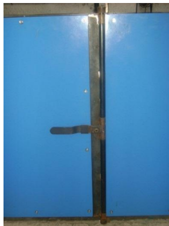
Figura 3. 5: Cerradura tipo barra mecánica. (Aguirre/Sánchez, Fotografías del horno Electrico 2013)
