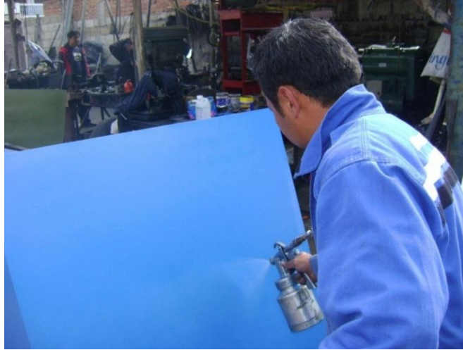
c.- Aplicación de la pintura de acabados.
