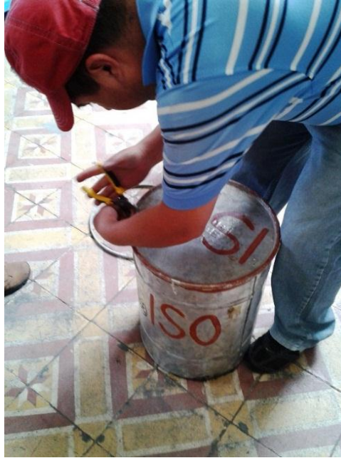
Figura 4. 1: Verificación de la hermeticidad del tanque de Polyol y Prepolymer. (Aguirre/Sánchez, Tanques de Polyol y Prepolymer 2014)
