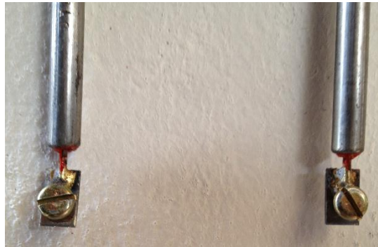
Figura 3. 9: Terminal de conexión utilizado. (Aguirre/Sánchez, Resistencia Electrica 2013)
