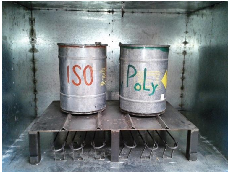
Figura 4. 2: Disposición del material en el horno. (Aguirre/Sánchez, Tanques de Polyol y Prepolymer 2014)
