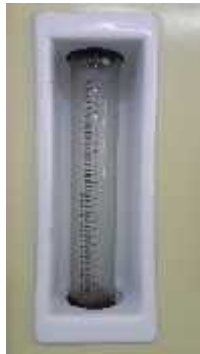
Figura 3. 54 Medidor de flujo de bomba centrífuga de agua
