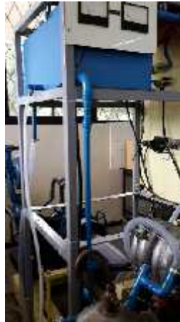
Figura 7. 19 Drenaje de agua de los sistemas del banco de pruebas
