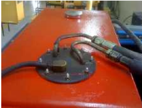
Figura 3. 25 Bomba de Combustible
