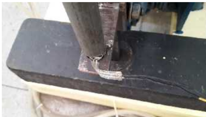
Figura 4. 26 Ubicación del sensor de fuerza
