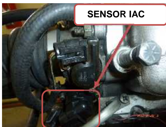
Figura 3. 22 Ubicación del actuador que controla la marcha ralenti
