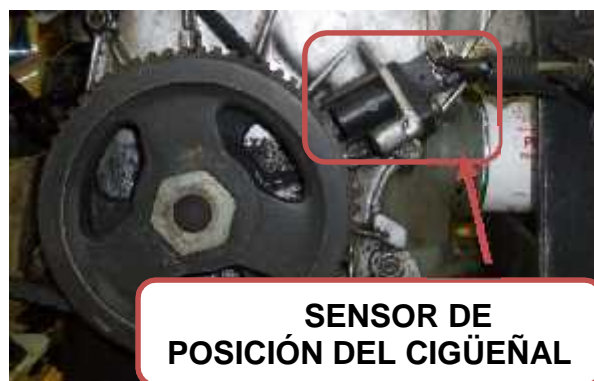
Figura 3. 20 Ubicación del sensor de posición del cigüeñal
