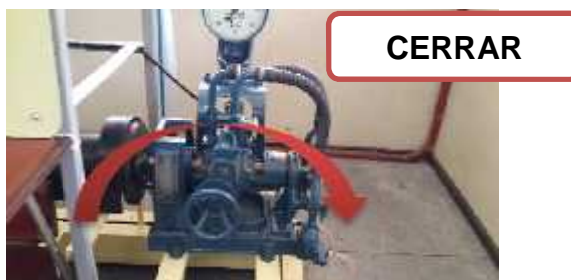
Figura 7. 14 Freno hidráulico en posición cerrada
