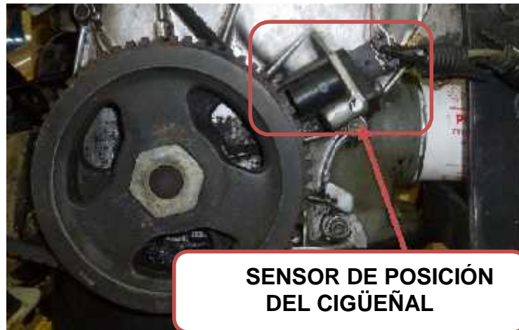
Figura 4. 22 Ubicación del sensor de revolución
