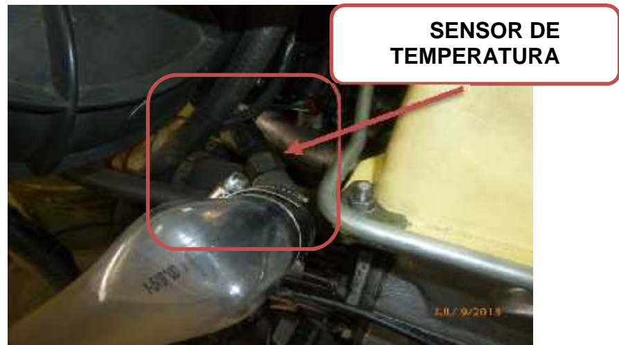
Figura 3. 7 Ubicación del sensor de temperatura del motor
