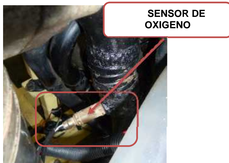
Figura 3. 16 Ubicación Del Sensor de Oxígeno o Sonda Lambda en el automóvil
