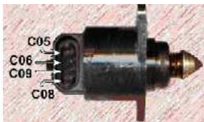
Figura 3. 21 Actuador que controla marcha ralenti en el motor
