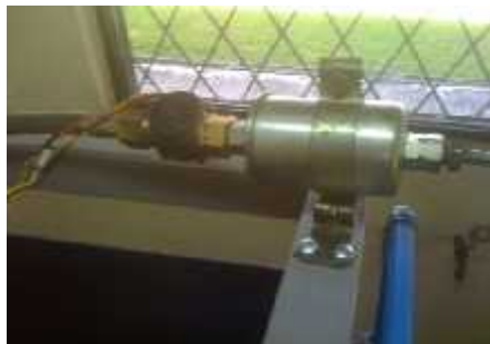
Figura 3. 28 Filtro de combustible
