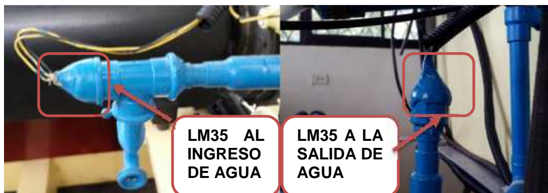
Figura 4. 12 Ubicación del sensor LM35
