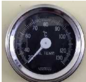
Figura 3. 50 Medidor de temperatura de aceite
