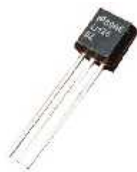
Figura 4. 7 Sensor de temperatura LM35
