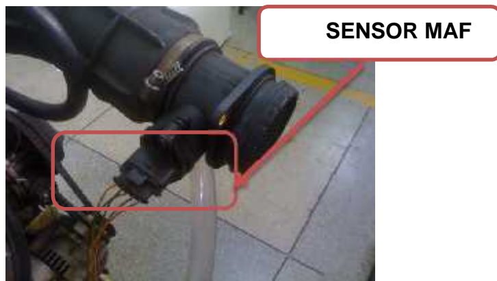
Figura 3. 9 Ubicación del sensor MAF
