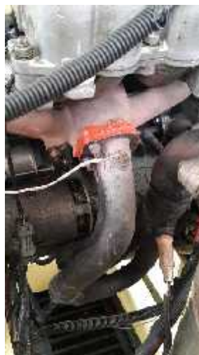
Figura 4. 17 Ubicación de la termocupla tipo K
