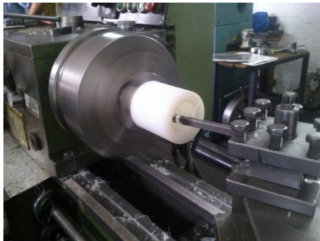
Figura 99 Torneado de los acoples de duralón
