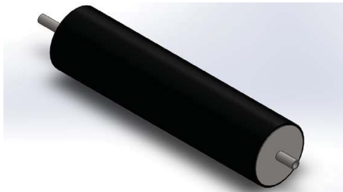
Figura 3.18 Diseño preliminar del rodillo para la banda transportadora proporcionado por ESPATEX.
