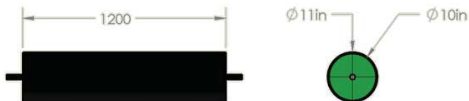
Figura 3.24 Longitud y diámetros del rodillo motriz y descargador.
