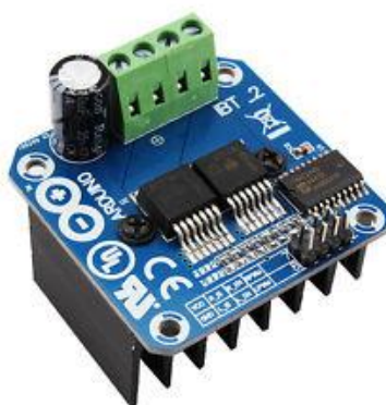
Figura 78 Driver de inversión de giro de 100W
