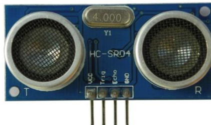
Figura 76 Sensor ultrasónico HC-SR04
