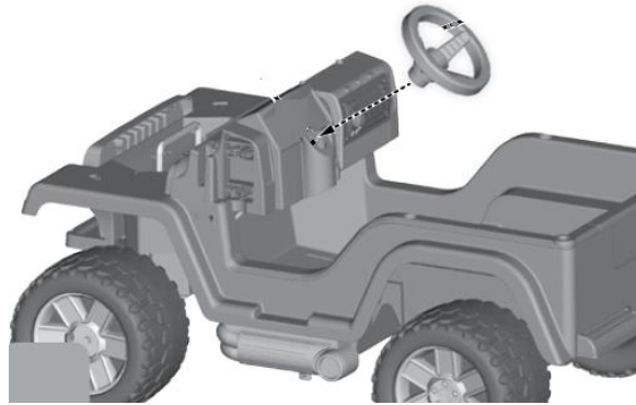
Figura 67 Vista lateral del sistema de dirección
