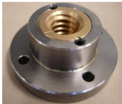
Figura 32 Tuerca de bronce y brida de acero
