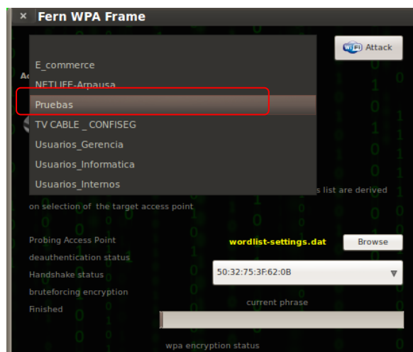
Figura 45. Selección del SSID de Pruebas dentro de la lista de SSIDs detectados por Fern WiFi Cracker
