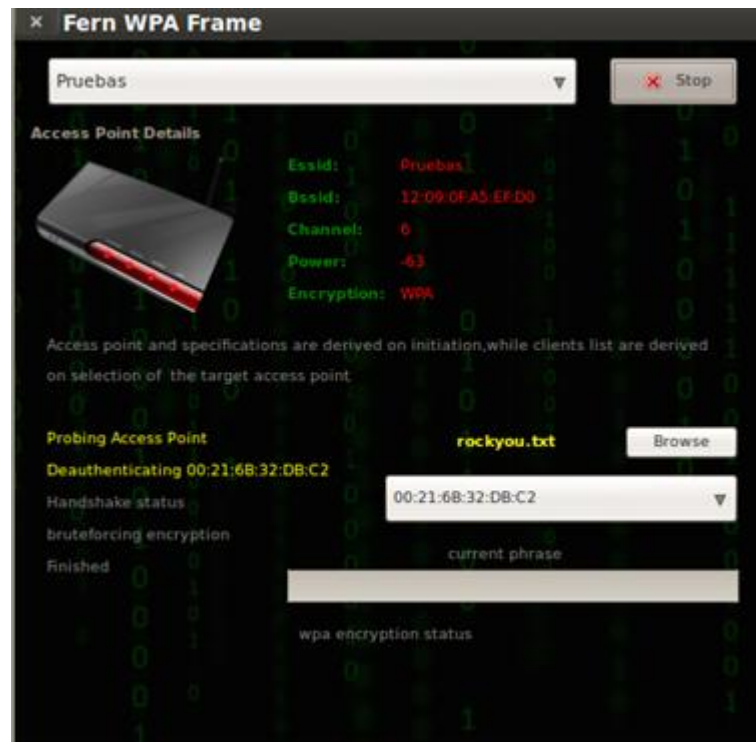
Figura 48. Ataque de diccionario en proceso en Fern WiFi Cracker hacia la WLAN “Pruebas” a través del Cliente B
