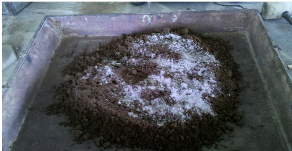
Figura 3.11: Suelo mezclado con el 1% de Cemento
