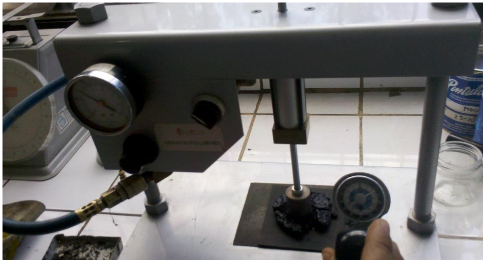
Figura 5.8: Ensayo de Cohesión al Micropavimento
