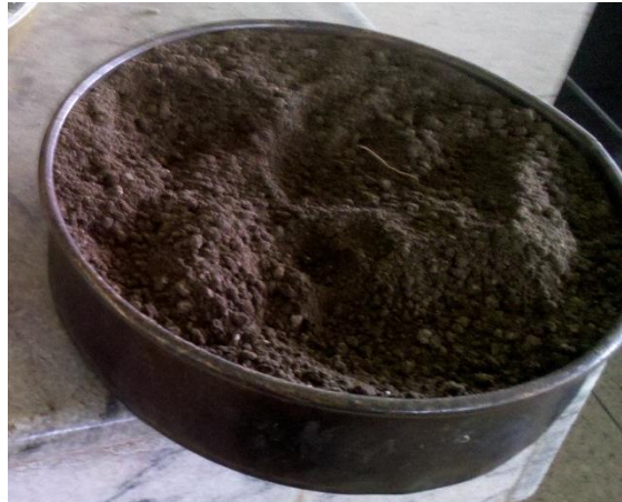
Figura 4.1: Muestra de Suelo de Tipo Limo Orgánico Arenoso
