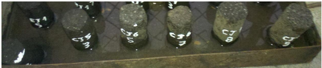
Figura 4.36: Probetas de Suelo-Cal en proceso de Ensayo de Capilaridad
