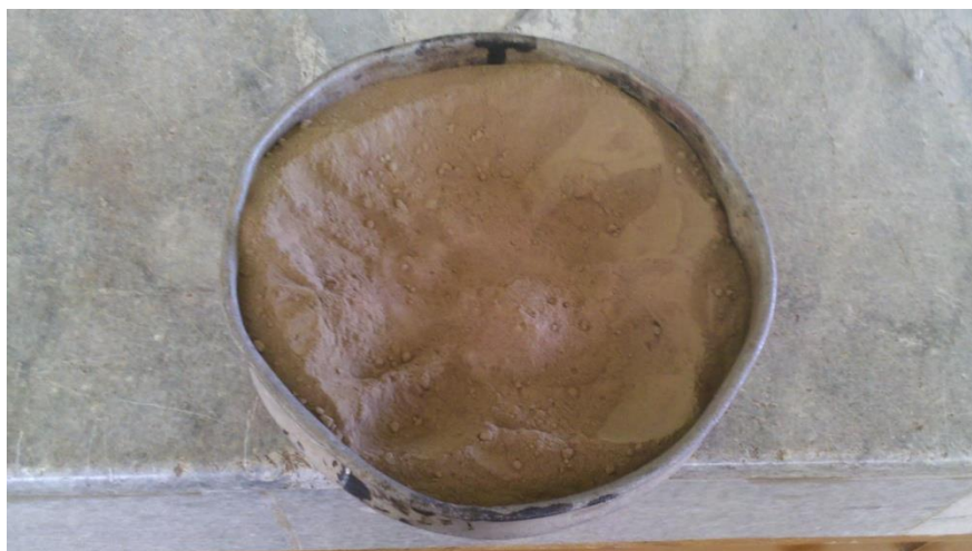
Figura 3.46: Mezcla de Suelo con Organo-Silanos.
