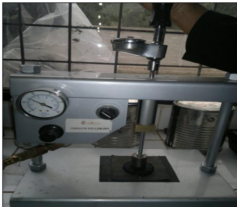
Figura 2.22: Equipo para Cohesión de micropavimentos
