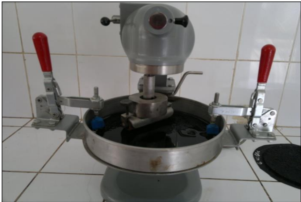
Figura 2.20: Equipo para Ensayo de Abrasión en Húmedo
