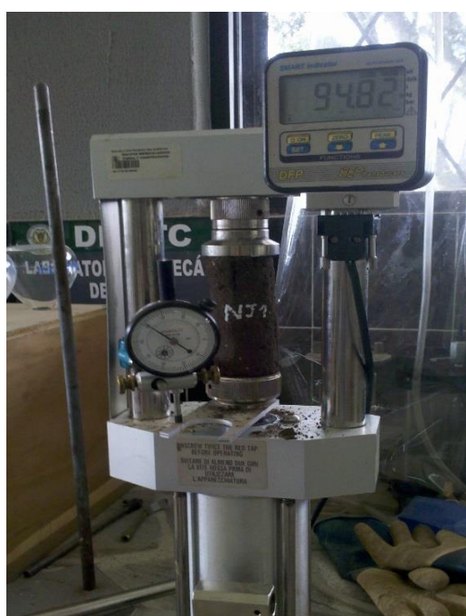
Figura 4.8: Ensayo de Compresión en Suelo Normal
