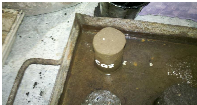
Figura 3.36: Probeta de suelo-cal en el ensayo de Capilaridad
