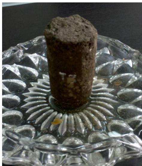
Figura 4.53: Probeta sumergida en agua con Absorción Capilar Nula
