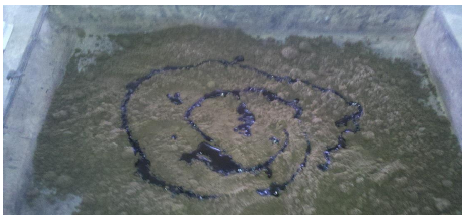
Figura 4.37: Suelo mezclado con el 3% de Emulsión Asfáltica
