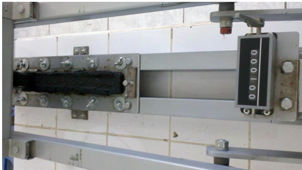
Figura 5.15: Ensayo de Rueda Cargada para Micropavimento
