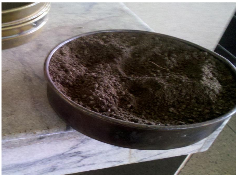
Figura 4.45: Suelo Mezclado con Organo-Silanos
