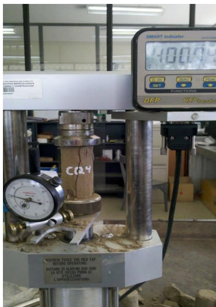
Figura 3.31: Ensayo de Compresión a la Probeta Suelo-Cal
