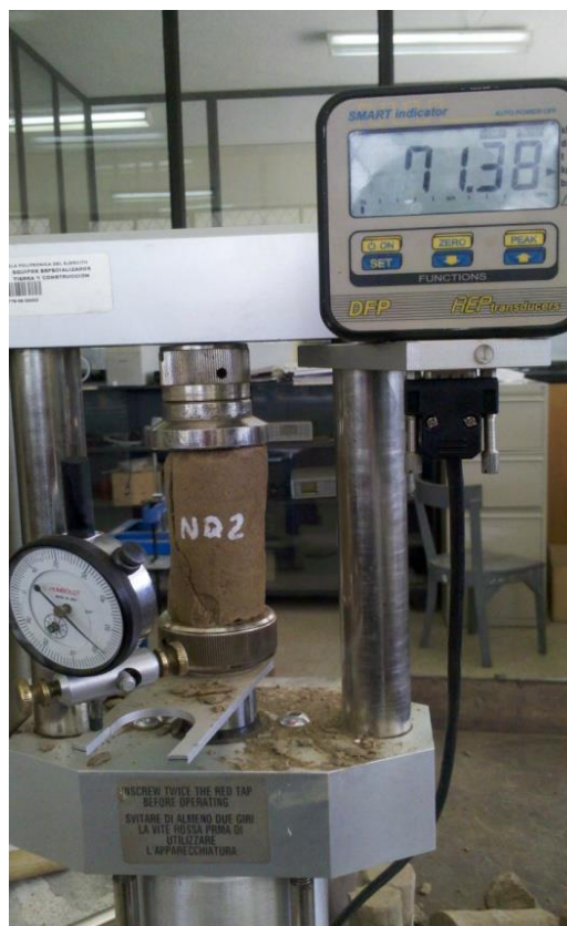
Figura 3.9: Ensayo de Compresión en Probeta de Suelo Natural
