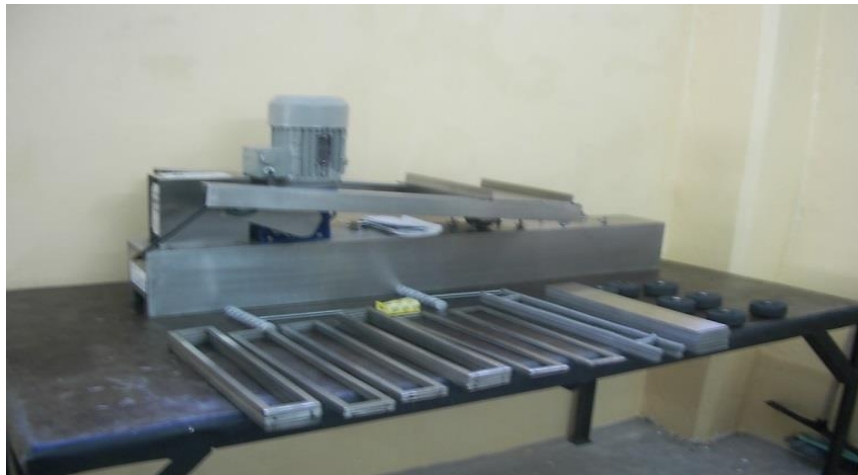
Figura 2.19: Elementos para el Ensayo de la Rueda Cargada
