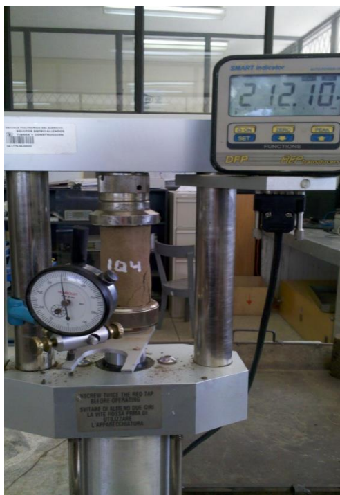
Figura 3.18: Ensayo de Compresión Simple en Suelo Cemento
