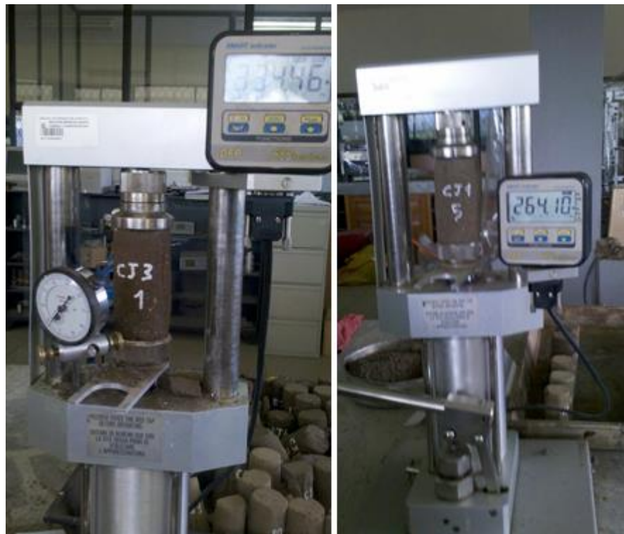
Figura 4.31: Ensayo de Compresión en las Probetas de Suelo-Cal
