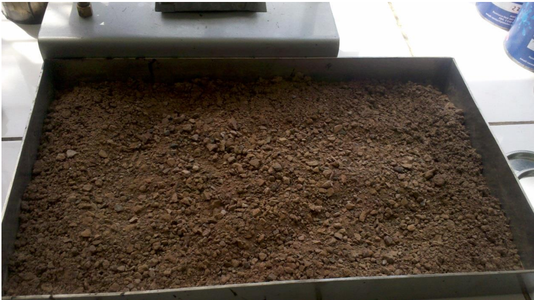
Figura 5.1: Agregado de la Mina de Pintag
