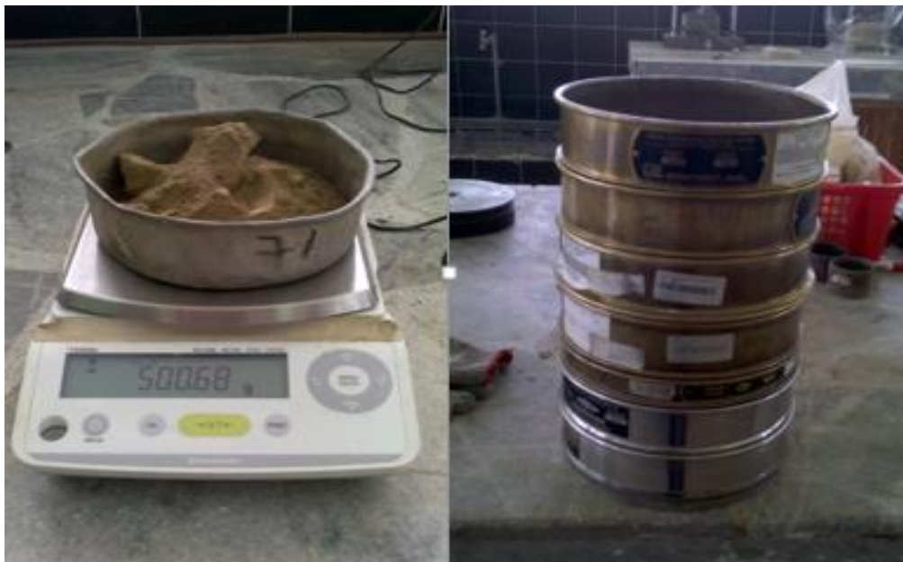
Figura 3.2: Proceso de tamizado según Norma ASTM D-136
