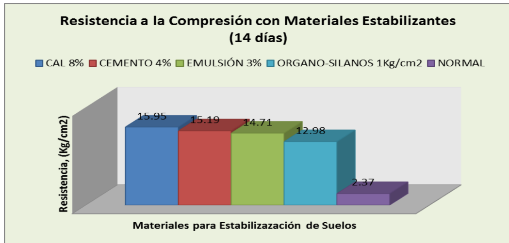
Figura 4.59: Gráfica de los valores de Resistencia a la Compresión a los 14 días para cada uno de los Productos estabilizantes
