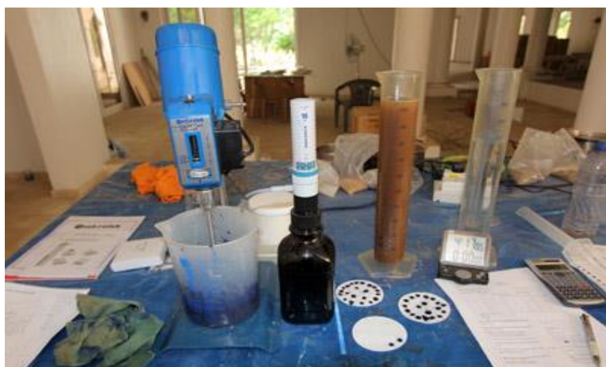
Figura 2.18: Equipo para ensayo de Azul de Metileno
