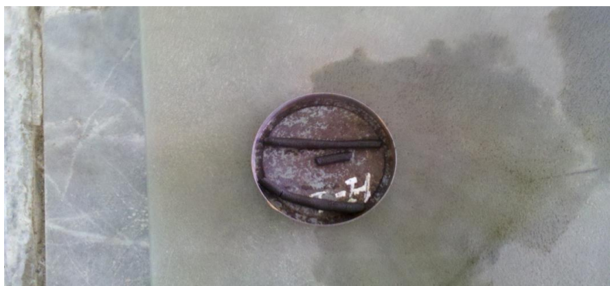
Figura 3.13: Ensayo de límite de plasticidad
