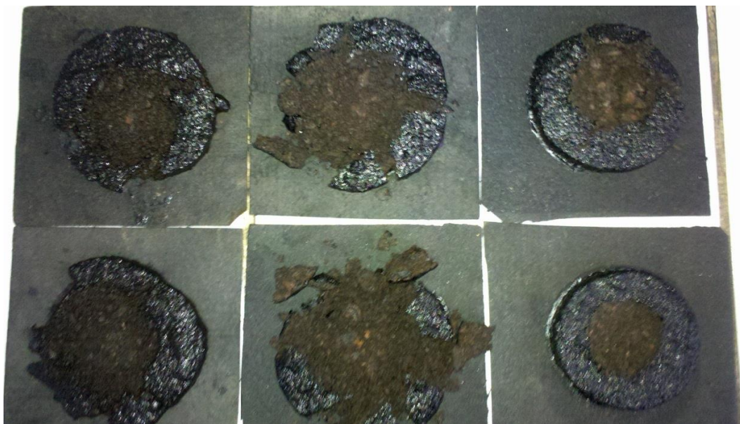
Figura 5.10: Muestras ensayadas por Cohesión de Micropavimento a los 60 minutos
