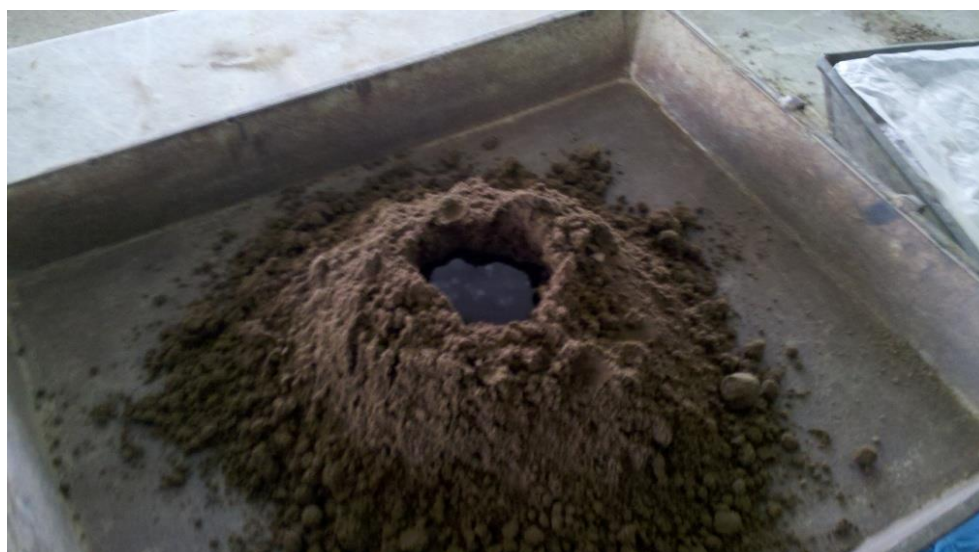
Figura 3.37: Mezcla de Suelo – 1.5% de Emulsión Asfáltica
