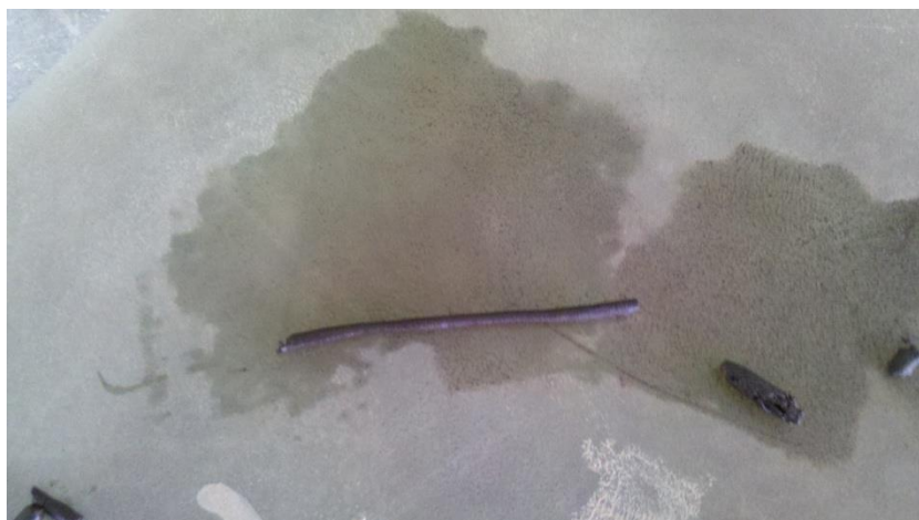
Figura 3.27: Ensayo de límite plástico
