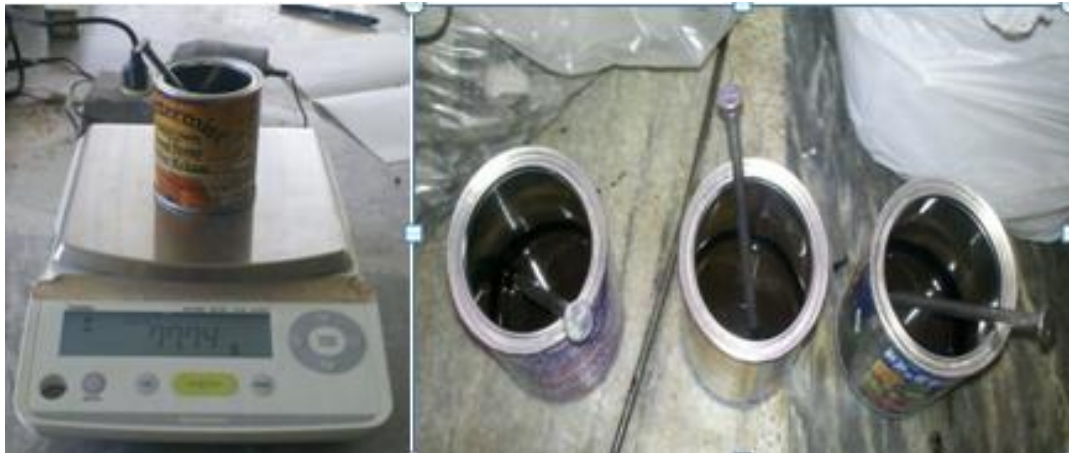
Figura 3.38: Muestras de Emulsión para obtener el porcentaje de agua
