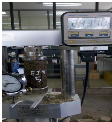
Figura 4.40: Ensayo de Compresión de Probeta Suelo-Emulsión
