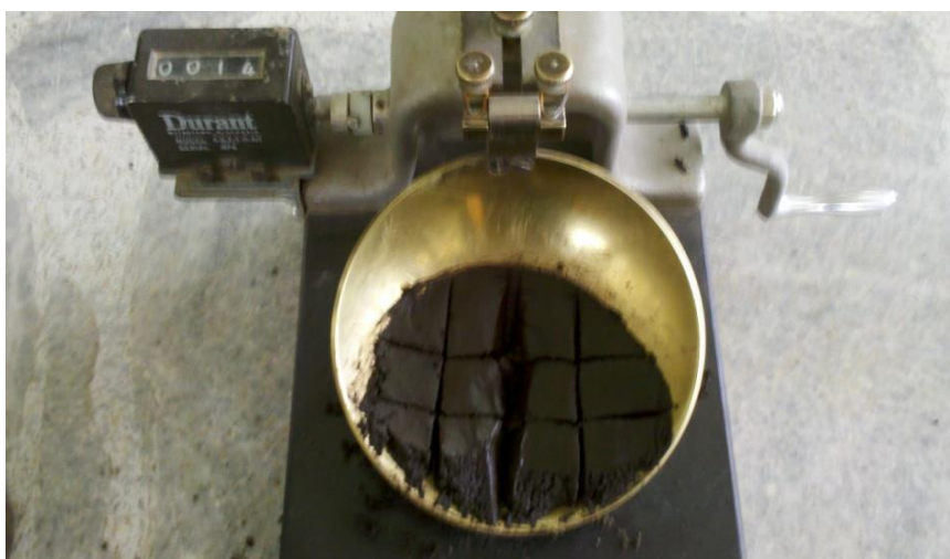
Figura 4.26: Ensayo de límite líquido. Casa Grande
