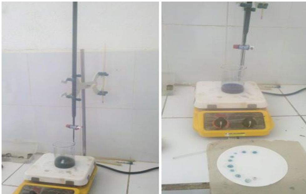
Figura 5.3: Ensayo de Azul de Metileno
