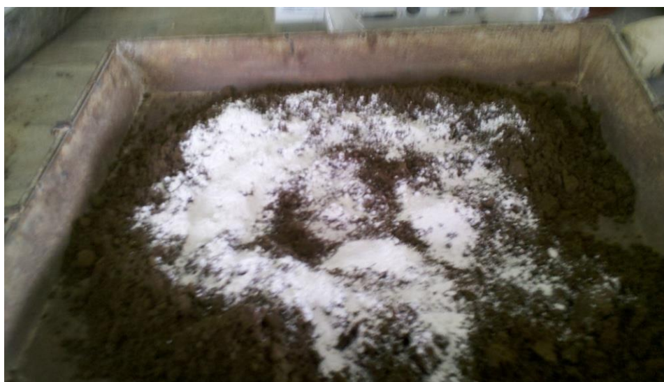
Figura 3.24: Suelo Modificado con el 2% de Cal.
