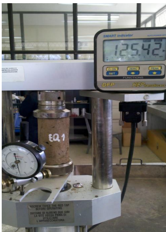
Figura 3.40: Ensayo de Compresión para la probeta Suelo-Emulsión Asfáltica
