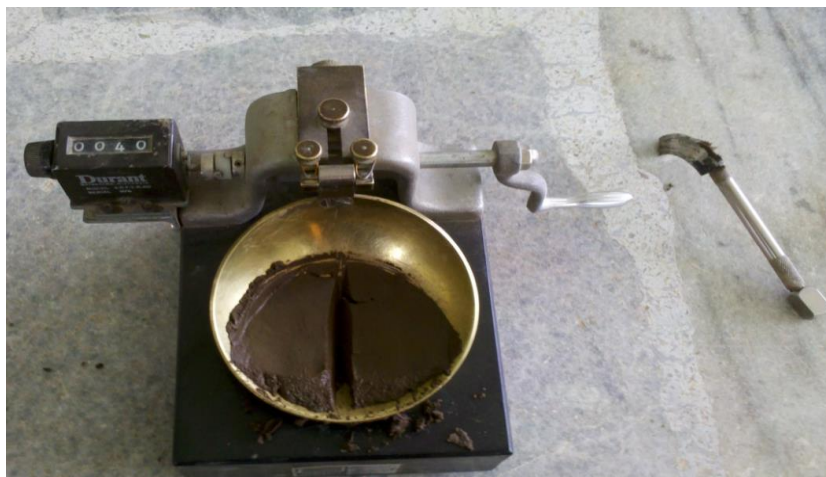
Figura 3.12: Ensayo de límite líquido
