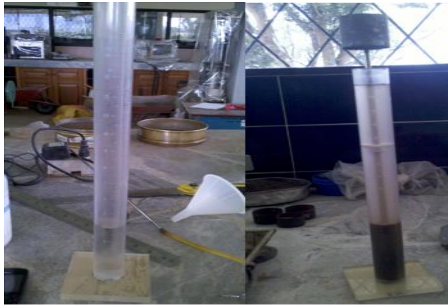
Figura 5.2: Ensayo de Equivalente de Arena
