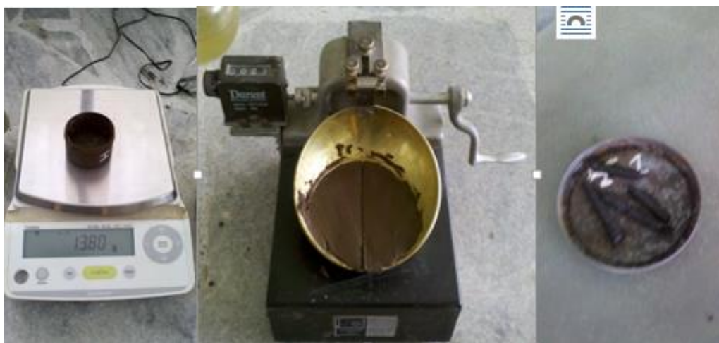
Figura 3.5: Ensayo de Límite Líquido y Límite Plástico
