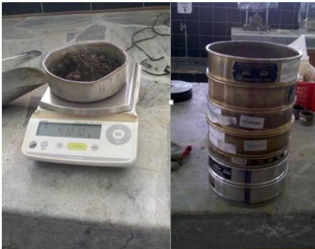
Figura 4.2: Ensayo granulométrico del Suelo
