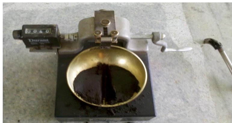
Figura 4.12: Ensayo de límite líquido
