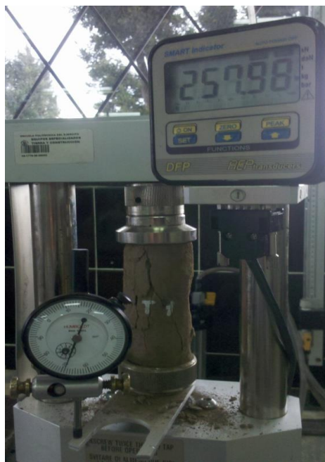
Figura 3.50: Ensayo de Compresión en Probeta de Suelo-ÓrganoSilanos
