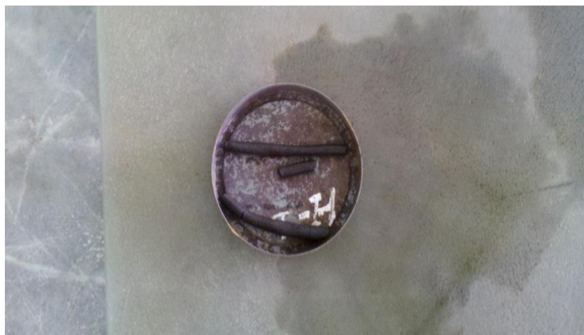
Figura 4.13: Ensayo de límite de plasticidad
