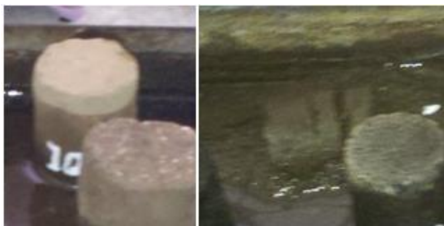
Figura 3.21: Probeta de Suelo-Cemento 1% durante el Ensayo
