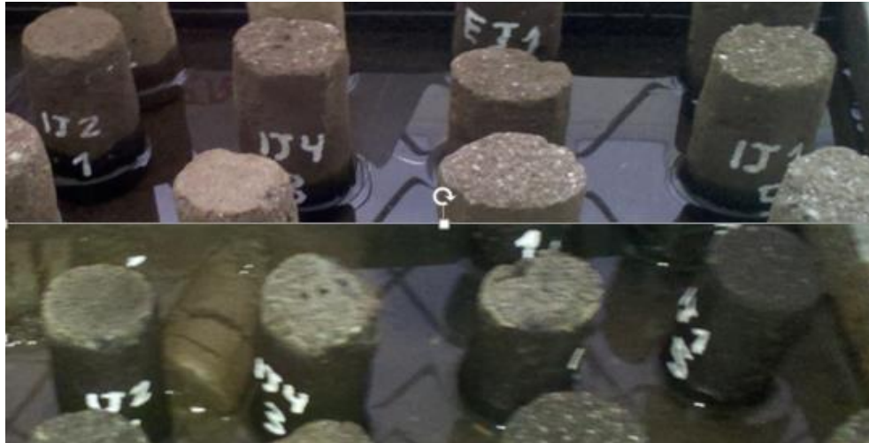
Figura 4.21: Probetas de Suelo-Cemento ensayadas por Capilaridad
