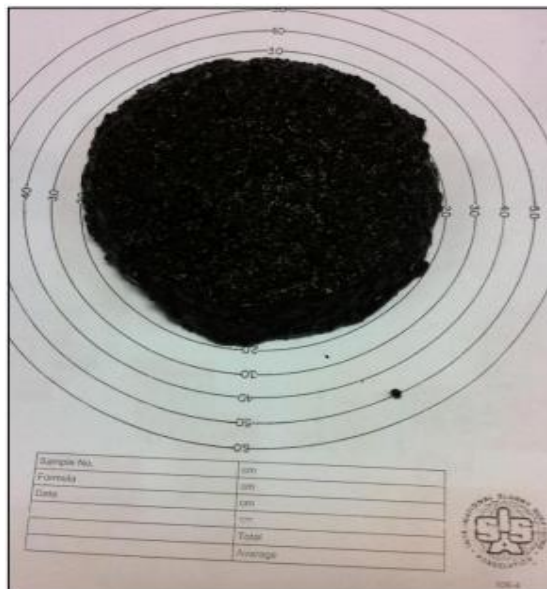
Figura 2.23: Ensayo de Consistencia de mezclas asfálticas
