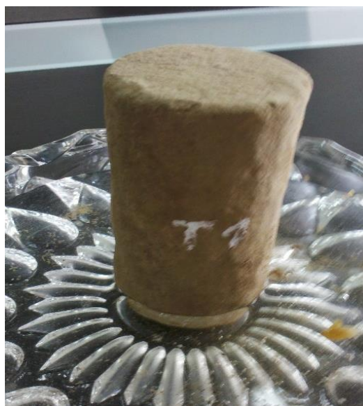
Figura 3.55: Probeta de Suelo-Organosilano (Impermeable)
