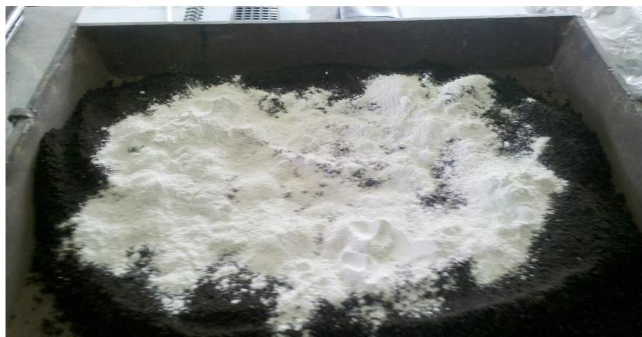
Figura 4.24: Mezcla de Suelo con el 8% de Cal
