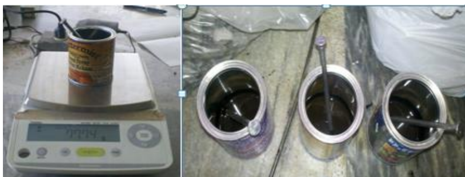
Figura 4.38: Ensayo de Contenido de Agua en la Emulsión Asfáltica
