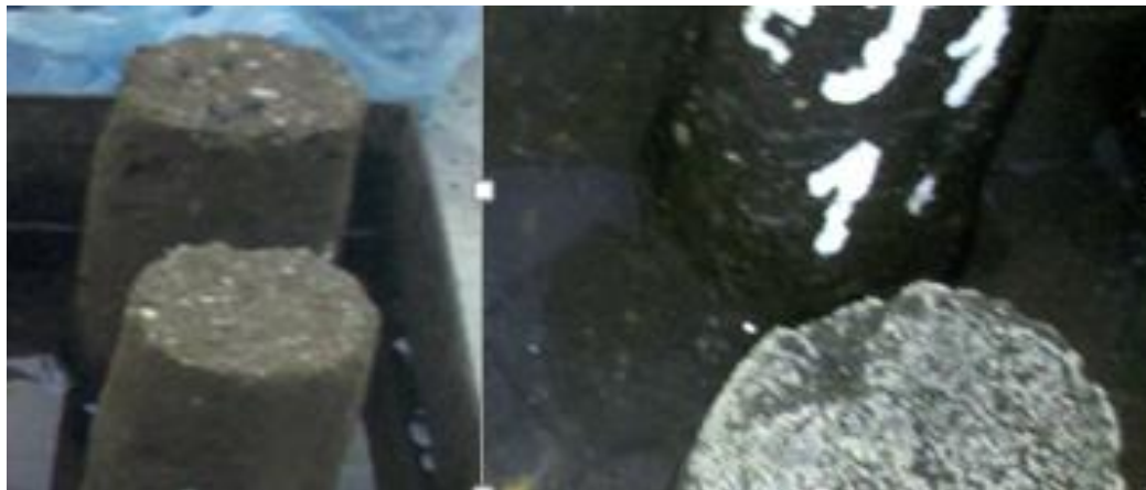
Figura 4.10: Probetas Ensayadas de Suelo Natural por Capilaridad
