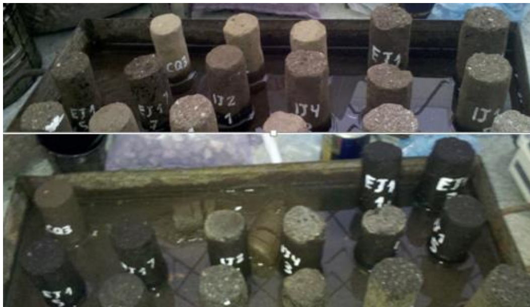
Figura 4.44: Probetas de Suelo-Emulsión Asfáltica sometidas al Ensayo de Capilaridad
