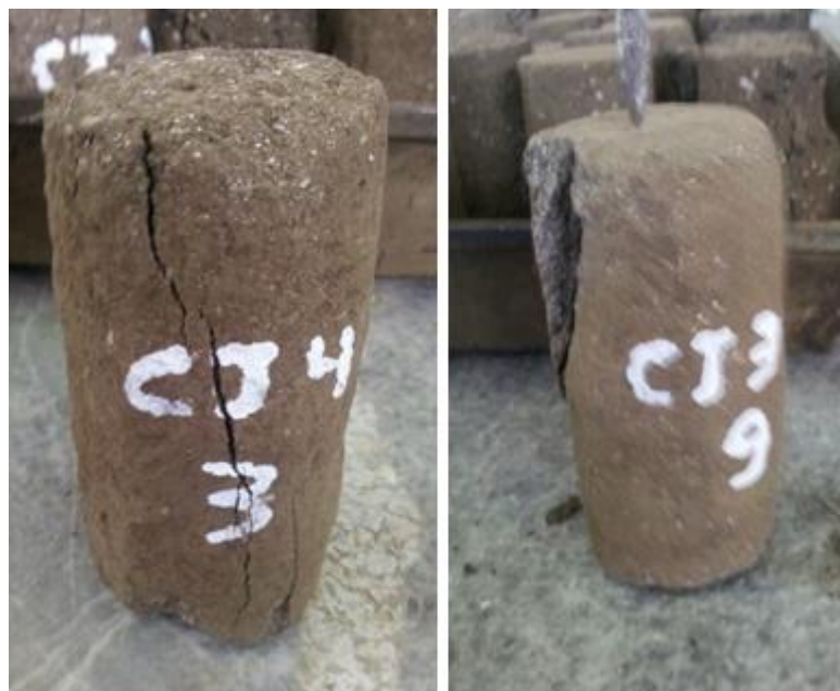
Figura 4.32: Probetas Ensayadas y con Falla Vertical
