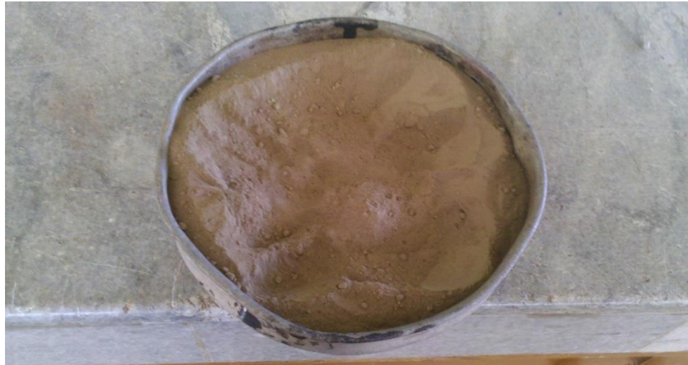
Figura 3.1: Muestra de Suelo de Tipo Limo Arenoso
