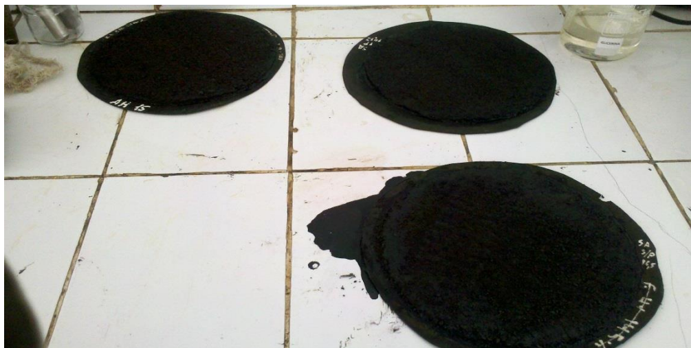
Figura 5.13: Moldes de Micropavimento para el Ensayo de Abrasión
