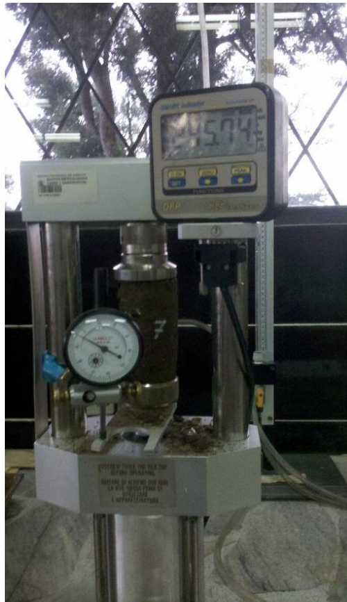
Figura 4.49: Ensayo de Compresión en Probeta de Suelo-ÓrganoSilano
