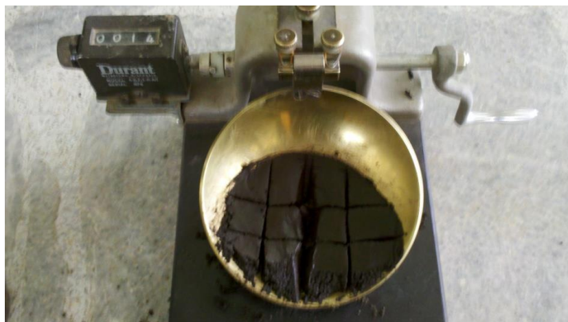
Figura 3.26: Ensayo de límite líquido. Casa Grande
