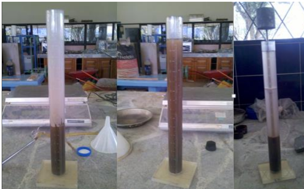
Figura 3.4: Resultados y proceso de Ensayo de Equivalente de Arena
