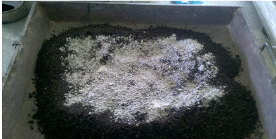
Figura 4.11: Suelo Mezclado con el 4% de Cemento
