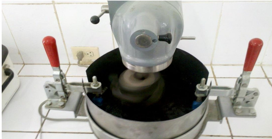
Figura 5.14: Ensayo de Abrasión en Húmedo del Micropavimento
