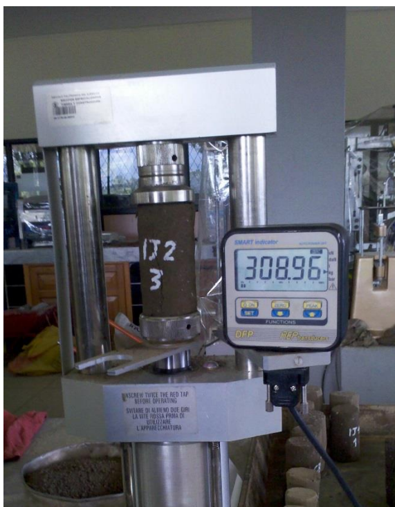
Figura 4.18: Ensayo de Compresión en Suelo – Cemento
