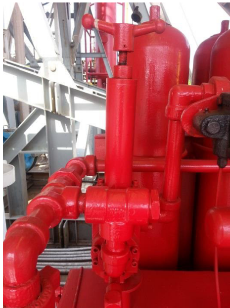
Figura 2.30. Válvula reguladora de presión, CPV-23.
