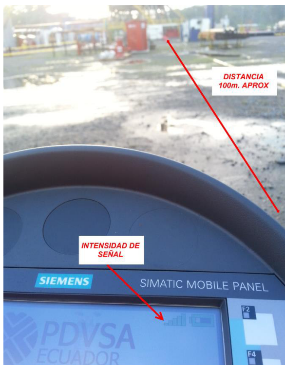
Figura 4.34. Intensidad de señal a 100 metros de distancia.
