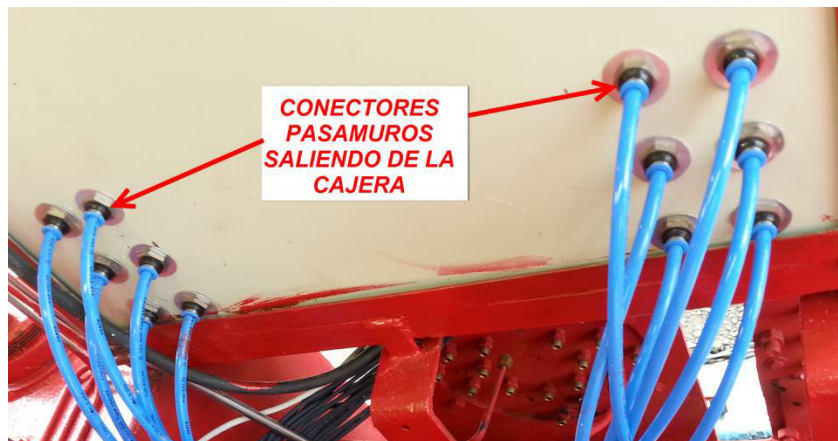
Figura 4.15. Conexión externa de conectores pasamuros
