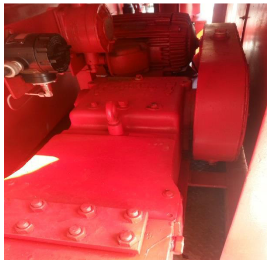
Figura 2.26. Bomba Triple del acumulador de presión, CPV-23.
