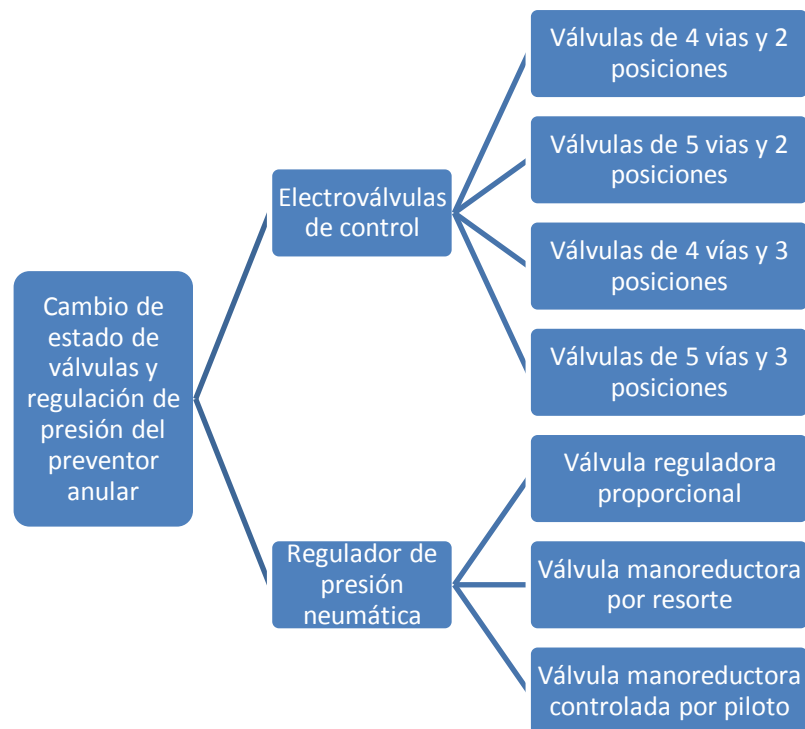
Figura 3.8. Árbol de Conceptos: Cambio de estado de válvulas y regulación de presión del preventor anular
