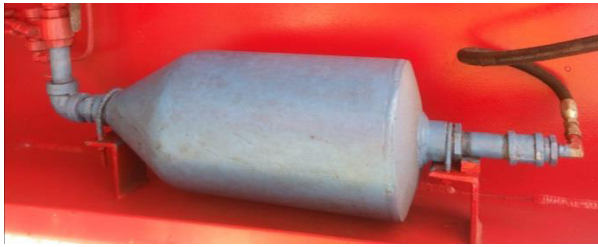
Figura 2.18. Reservorio de panel remoto original.
