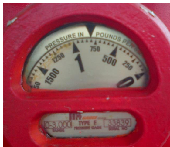
Figura 2.34. Manómetro del anular, CPV-23.
