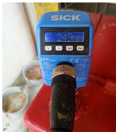
Figura 4.70. Calibración del sensor de nivel TDR desde su pantalla.
