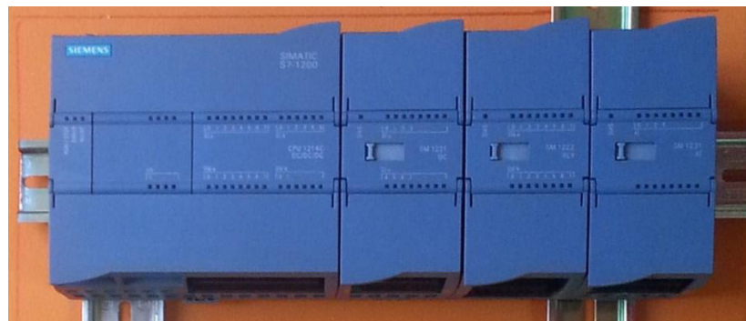
Figura 4.30. Montaje de PLC en rieles DIN
