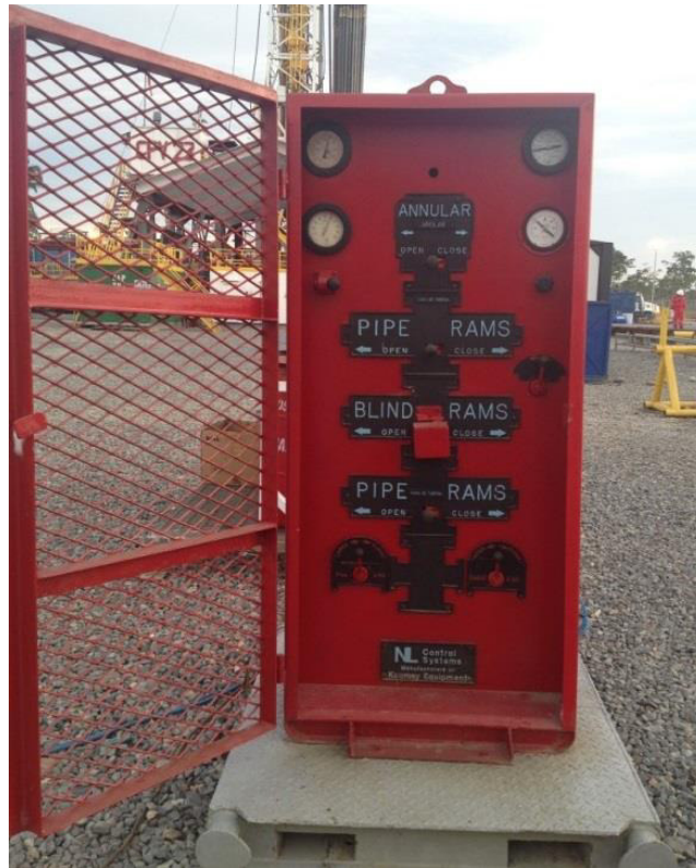
Figura 2.43. Control Remoto del Acumulador de Presión del CPV-23
