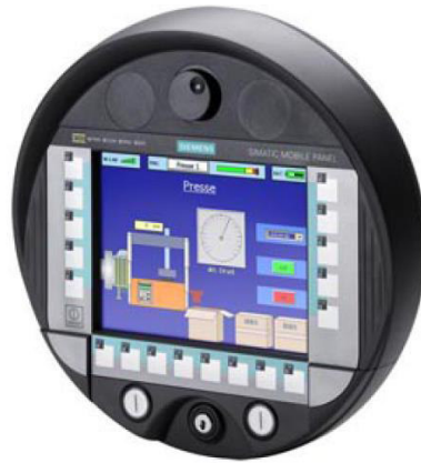
Figura 3.105. Panel móvil, SIMATIC IWLAN 277
