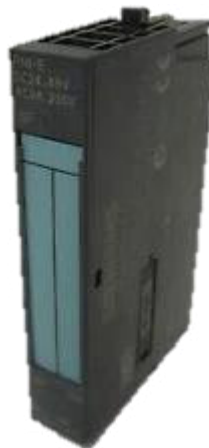
Figura 3.85. Módulo de Potencia PM-E DC24.
