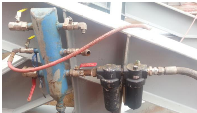
Figura 4.9. Unidad FRL de la línea principal.
