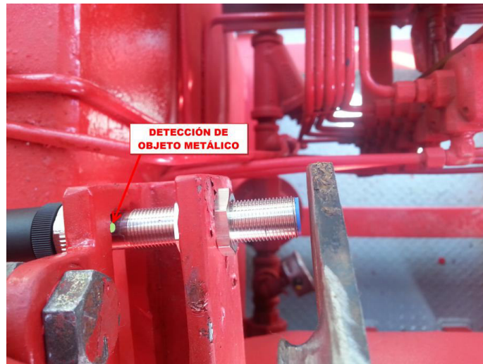
Figura 4.54. Verificación de sensado de palanca de válvulas.
