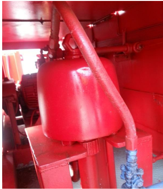
Figura 2.24. Bomba neumática, CPV-23.
