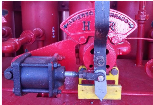
Figura 2.35. Válvula hidráulica de 4 vías, CPV-23.
