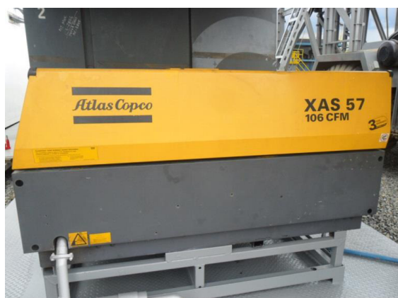
Figura 3.16. Compresor ATLAS COPCO XAS 57
