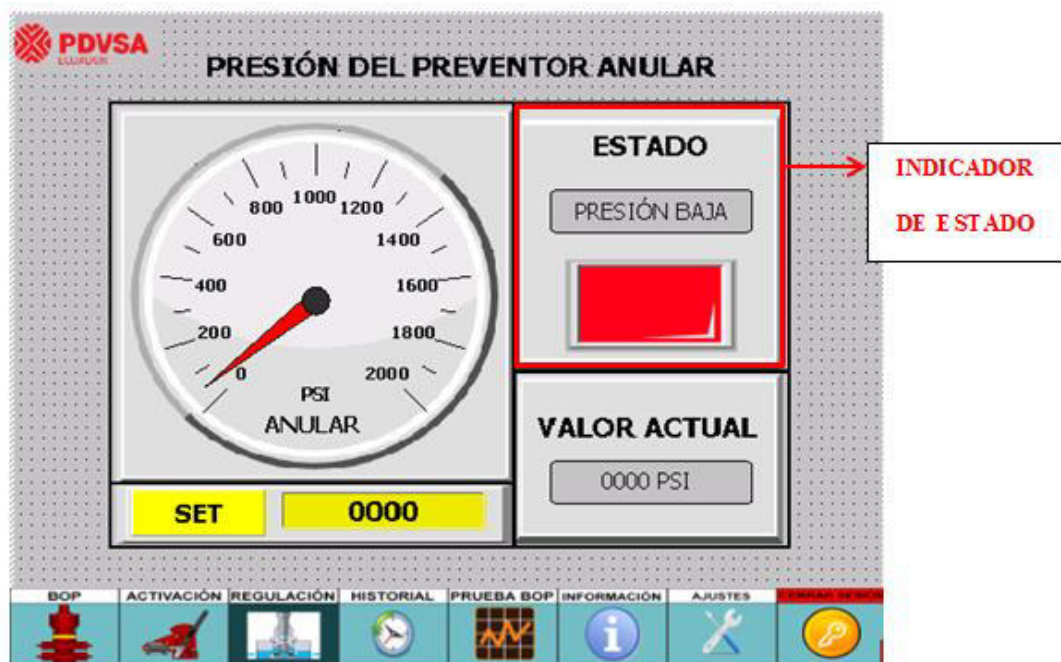
Figura 3.136. Indicador de estado de alarma de presión del preventor anular.
