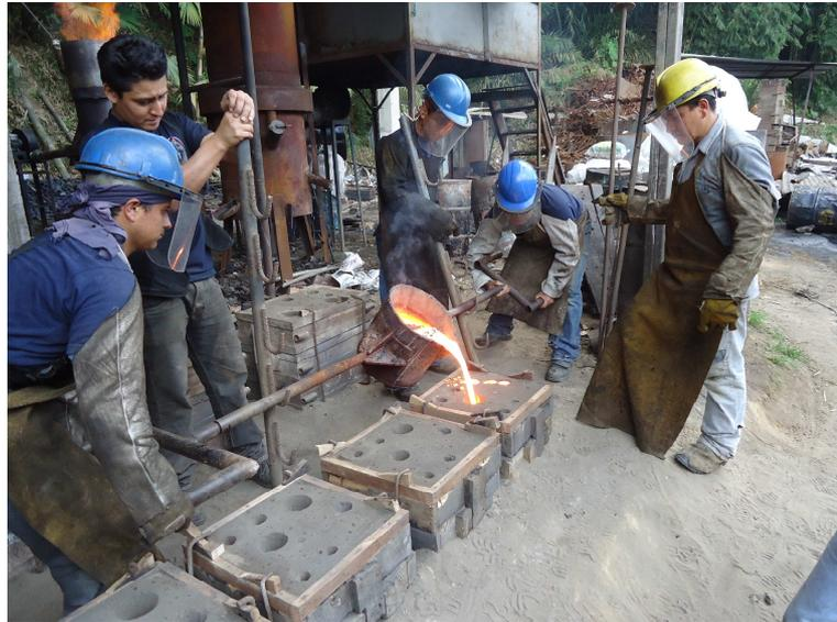
**Figura 25 Colado de fundición**
