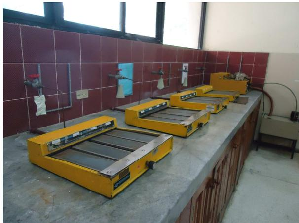
**Figura 43 Equipo para realizar operaciones de desbaste – DECEM ESPE**
