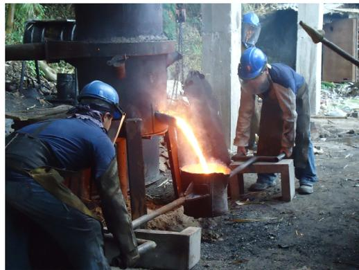
**Figura 27 Fusión y carga de metal líquido**
