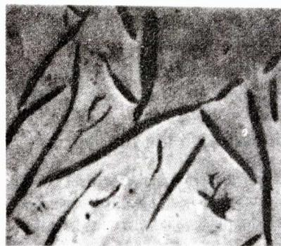
**Figura 6 Fundición gris, en la primera parte esquema de grafito y en la segunda parte micrografía de hojuelas de grafito en hierro gris (x100)**
