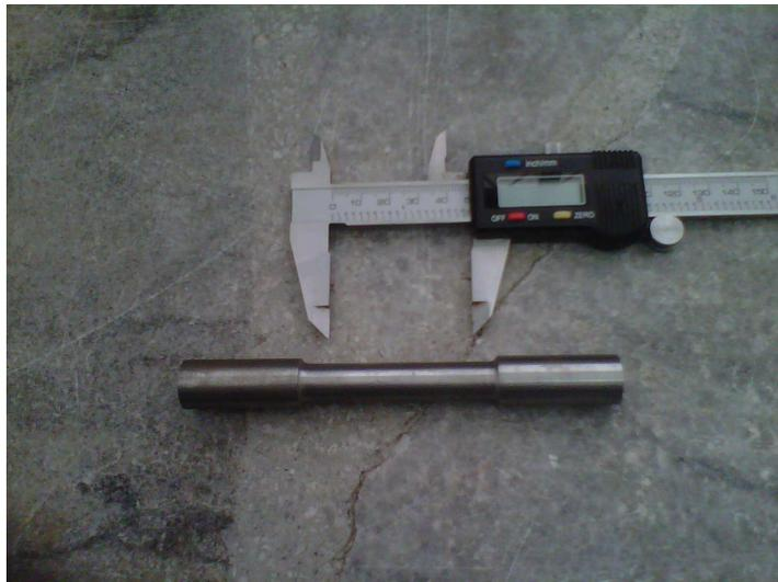
**Figura 39 Verificación de dimensiones según norma ecuatoriana**
