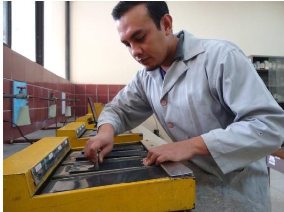
**Figura 44 Equipo para realizar operaciones de desbaste – DECEM ESPE**
