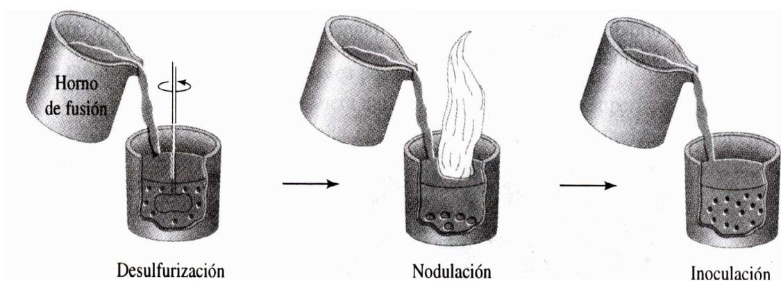
**Figura 11 Diagrama esquemático del tratamiento de la fundición nodular.**
