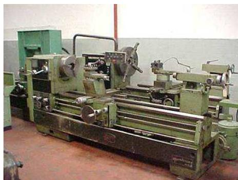
**Figura 35 Torno para maquinado del tambor de freno**
