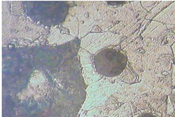
**Figura 51 Microestructura de la fundición observada mediante microscopio 400x**
