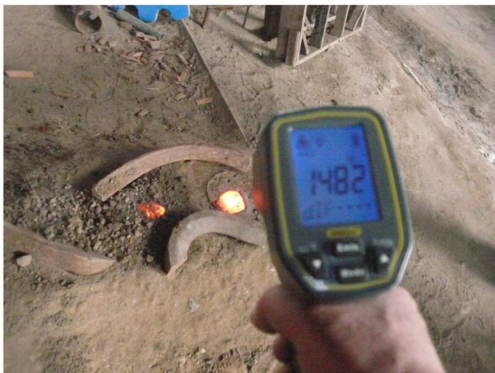
**Figura 34** Temperatura del metal fundido medido con pirómetro
