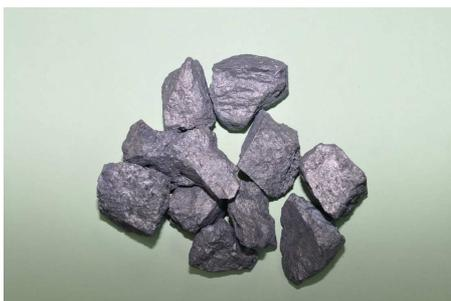
**Figura 13 Nodulizante Ferrosilicio**
