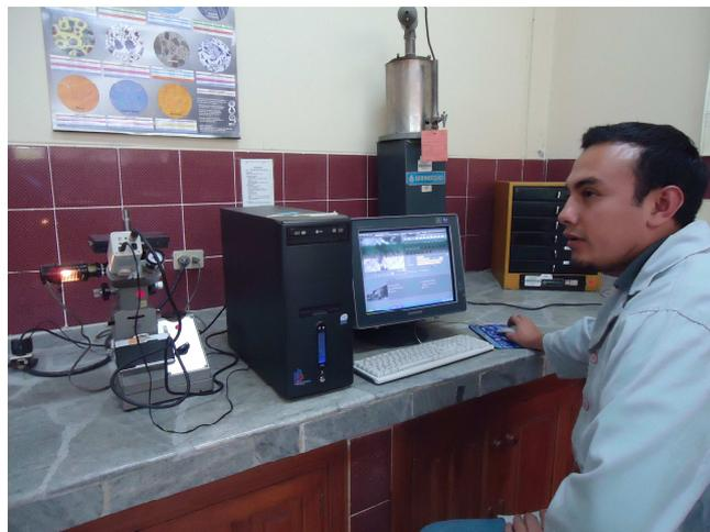
**Figura 42 Equipo microscopio óptico y computadora en Laboratorio de Metalografía – DECEM ESPE**
