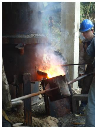
**Figura 28 Nodulización del metal líquido**
