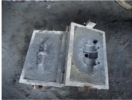
**Figura 26 Molde de arena para fundición**
