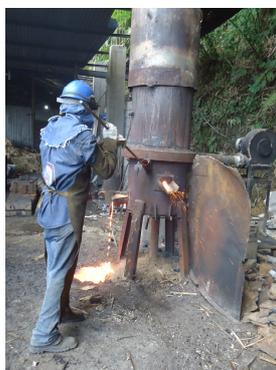
**Figura 17 Cubilote de carga 150 Kg.**
