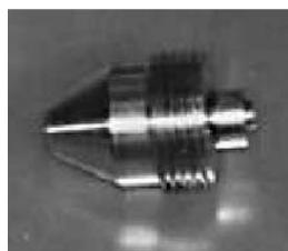
**Figura 4. 16 Encapsulado fuente radioactiva**
