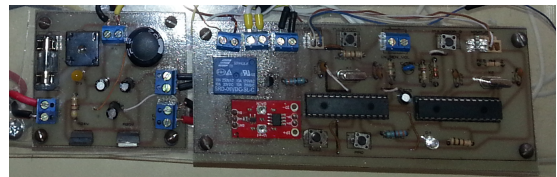
Figura 13: Controlador y fuentes implementados.
