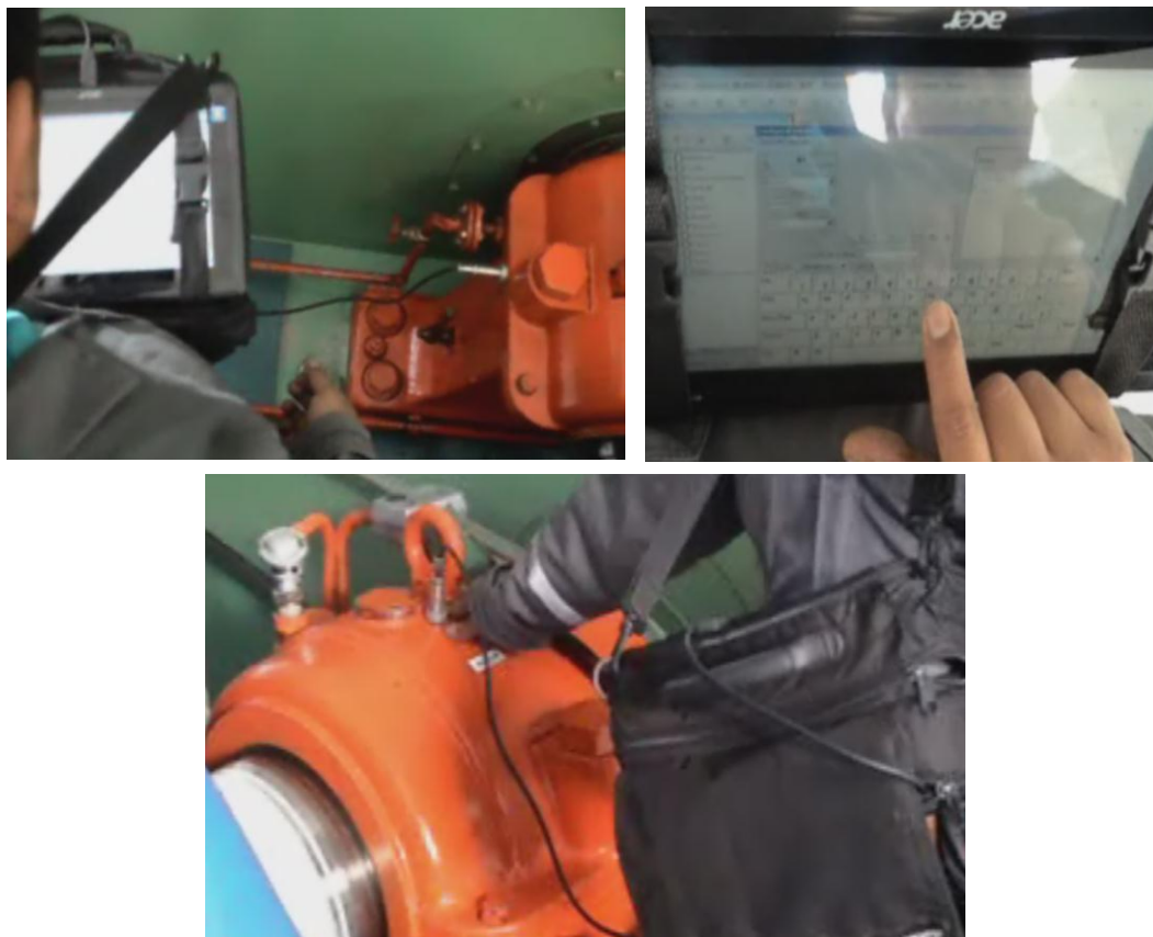
Figura 4.14 Fotografía de prueba de análisis de vibraciones
