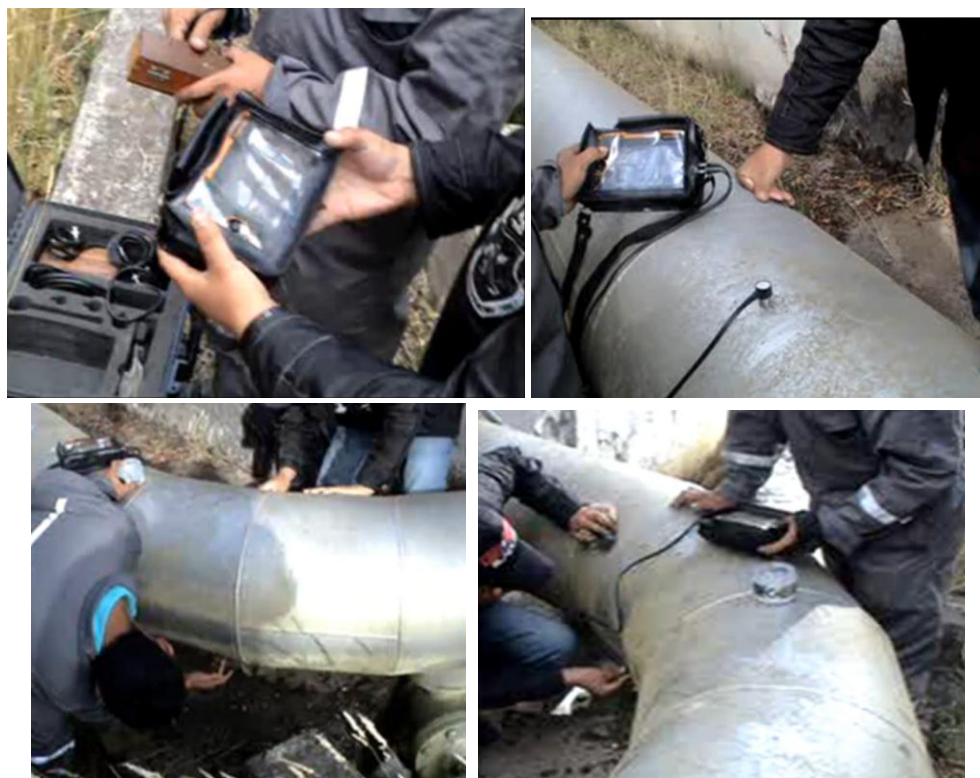
Figura 4.13 Fotografía de pruebas ultrasonido
