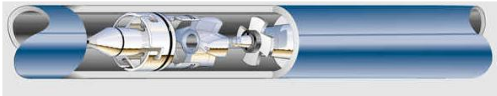
Vista de sección de la herramienta ImPulse (Schlumberger ImPulse, 2013)
