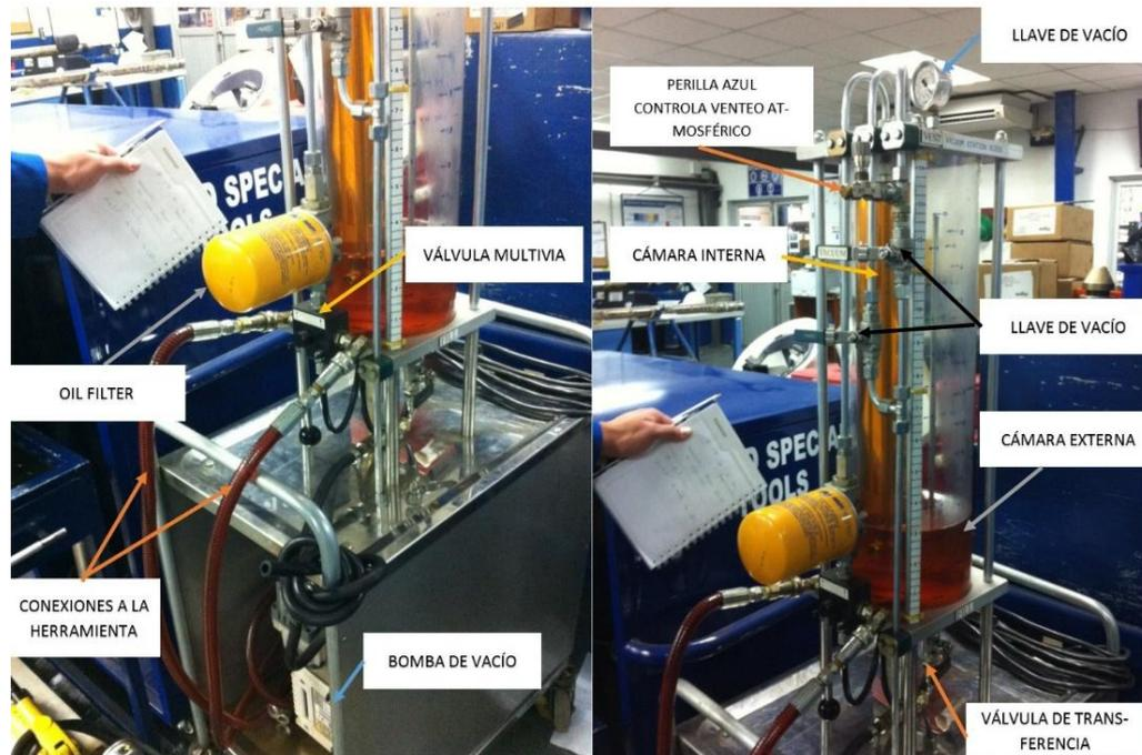
**Ilustración 2.12 Estación de llenado para Xceed (Elaboración propia, en base a fotografías tomadas en la base de Schlumberger – El Coca).**
