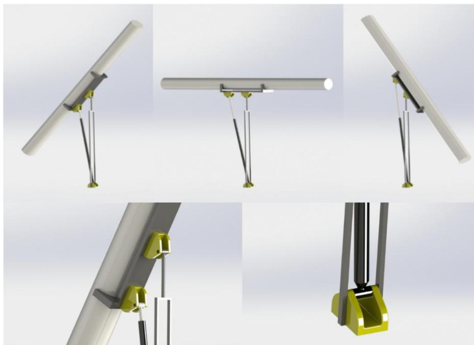
**Ilustración 3.6 Propuesta del mecanismo de giro del módulo.**
