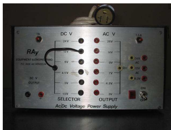
Fig. 6.13 Fuente de alimentación de Baja tensión
