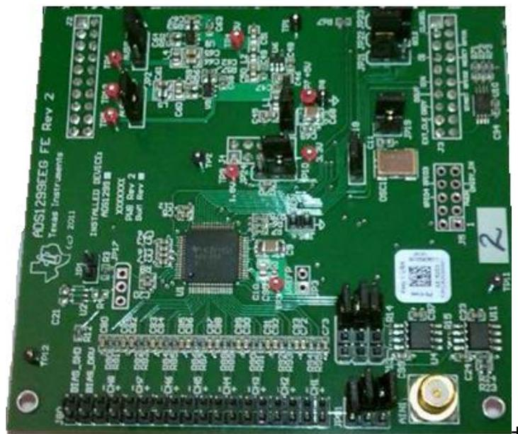
Figura 29 Tarjeta ADS1299EEG-FE
