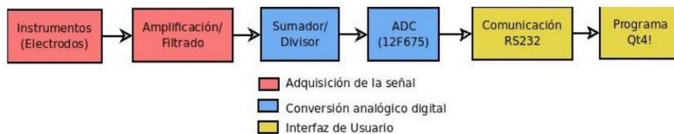
Figura 8 Diagrama de bloques del sistema
