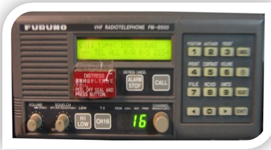
Figura 3 Transreceptor VHF-FM Furuno 8500
