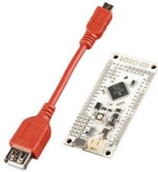
Figura 31. Conexión tipo Micro USB-B
