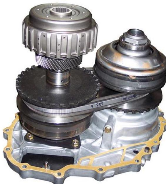
**Figura 2. 19 CVT – Poleas de Diámetro Variable**
