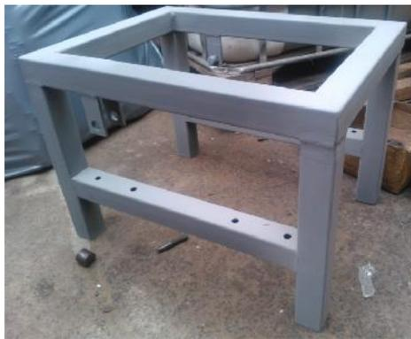
**Figura 4. 2 Bancada con soportes soldados**
