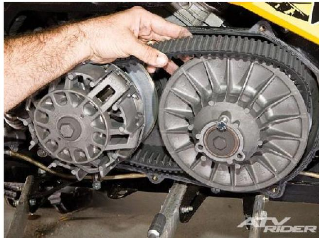
**Figura 2. 27 Correa de transmisión fabricada de caucho**
