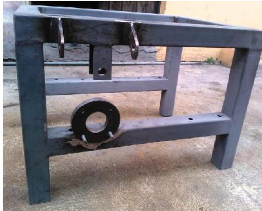
**Figura 4. 5 Bancada con brida para motor**
