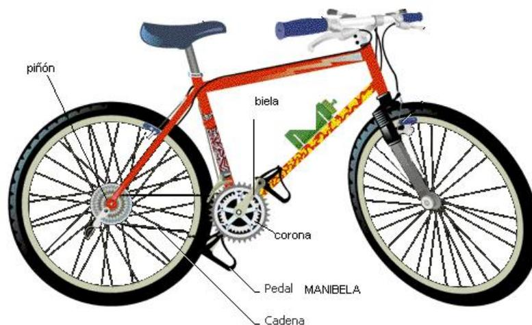
**Figura 2. 17 Sistemas de transmisión de una bicicleta**
