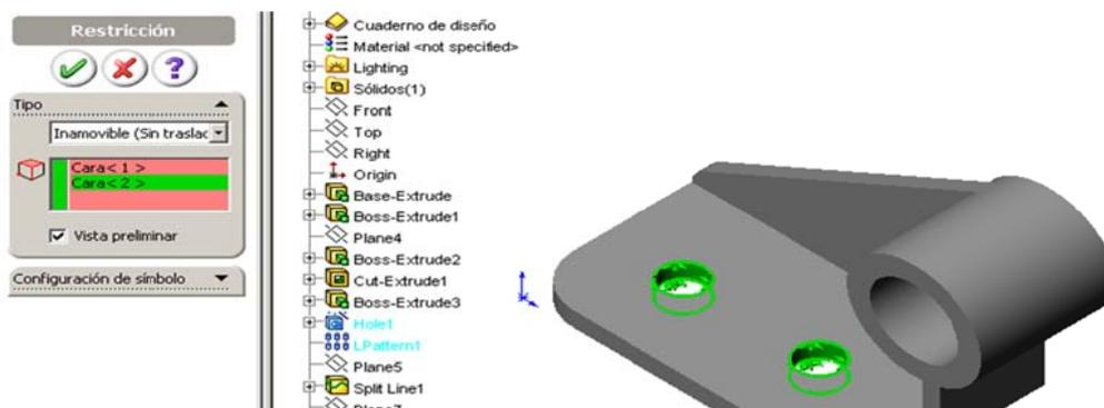
Figura 2.31 Creación de restricciones SolidWorks.
