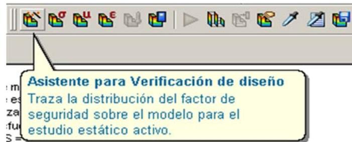
**Figura 2.40** Ícono de verificación de diseño SolidWorks.
