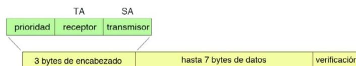
**Figura. 3.14. Estructura típica del mensaje OBD para las normas SAE J1850, ISO 9141-2 e ISO 14230-4**
