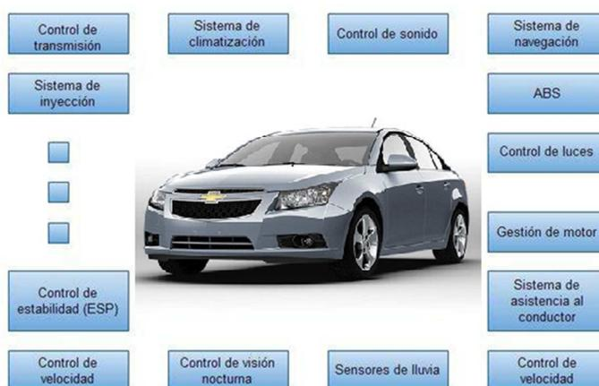
**Figura. 3.4. Ejemplos de sistemas de control, diagnóstico, notificación, que incorporan los automóviles modernos.**
