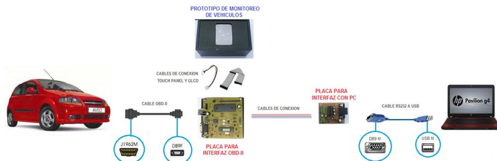
**Figura. 6.14. Diagrama de conexión**
