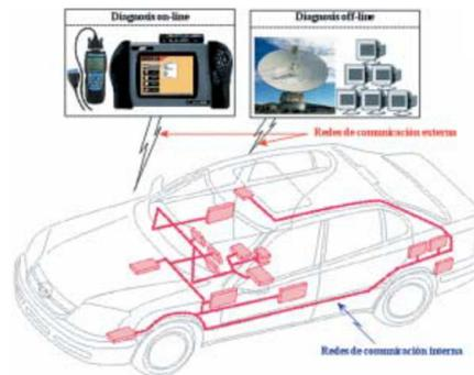
**Figura. 3.5. Tipos de redes o buses de comunicación implantadas en los vehículos: red interna y externa**
