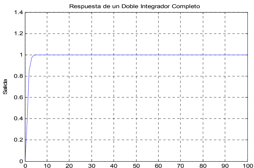
Figura 4.2.4. Respuesta de un Controlador para un Doble Integrador Digital en Feedforward y Feedback
