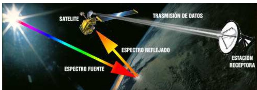
Figura 3. Esquema operativo de Satélites de Observación. Fuente. MundoGeo
