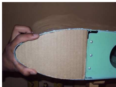
Figura 4.75. Comprobación de coincidencia del molde del cartón sobre el perfil alar.
