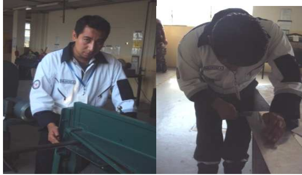
Figura 4.22. Corte y Limado de la lámina. Fuente: Investigación de Campo. Editado por: Luis Calderón.
