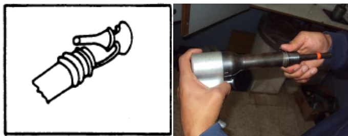
Figura 3.42. Resorte de retención de la Buterola. Fuente: Investigación documental y de campo. Tomado de: Manual de la IAAFA y fotografías.
