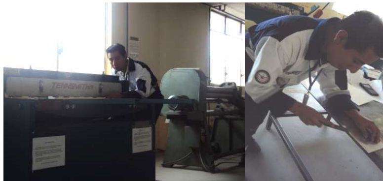
Figura 4.30. Corte y Limado de la lámina. Fuente: Investigación de Campo. Editado por: Luis Calderón.
