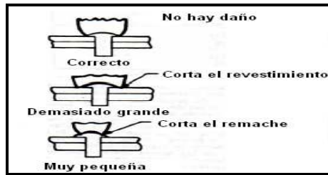
Figura 4.153. Buterolas Correctas e Incorrectas. Fuente: Investigación documental. Tomado de: Manual de la IAFA.
