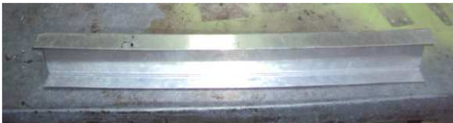
Figura 4.19. Viga del Borde de Salida (Rear spar). Fuente: Investigación de Campo. Editado por: Luis Calderón.
