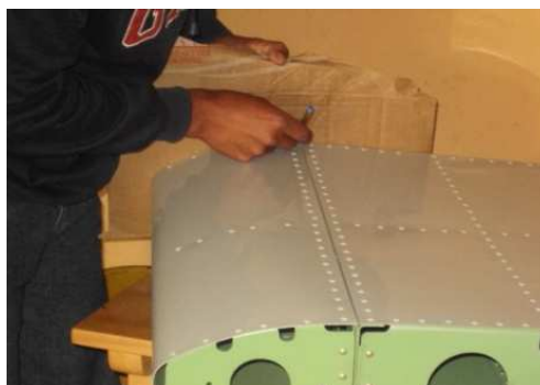
Figura 4.73. Trazado del molde de la costilla delantera falsa sobre el cartón. Fuente: Investigación de campo. Editado por: Luis Calderón.
