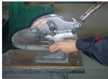
Figura 4.101. Cortado de los trazos en las pestañas laterales. Fuente: Investigación de campo. Editado por: Luis Calderón.
