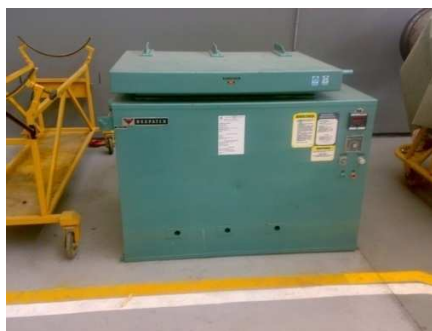
Horno de tratamiento térmico
