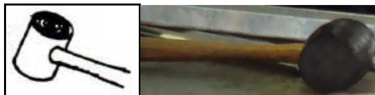
Figura 3.30. Maceta. Fuente: Investigación documental y de campo. Tomado de: Manual de la IAAFA. Editado por: Luis Calderón.
