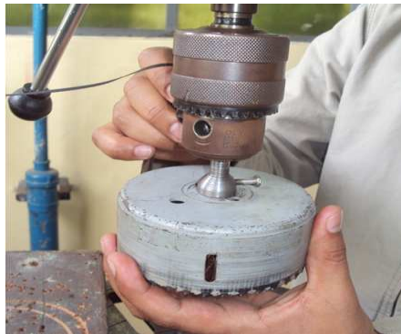
Figura 3.7. Instalación del conjunto de la broca de corona en el taladro de pedestal. Fuente: Investigación de campo. Editado por: Luis Calderón.
