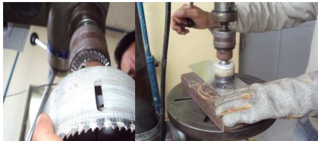
Figura 4.32. Perforación de agujeros de aligeramiento. Fuente: Investigación de campo. Editado por: Luis Calderón.
