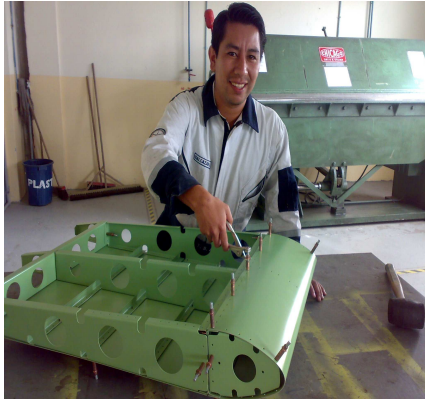
Partes aplicadas el anticorrosivo.
