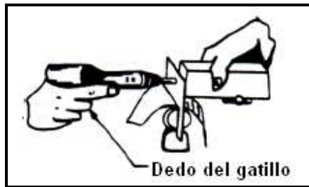
Figura 4.155. Posición de la Pistola Remachadora y de la Barra Contra-remachadora. Fuente: Investigación documental. Tomado de: Manual de la IAAFA.
