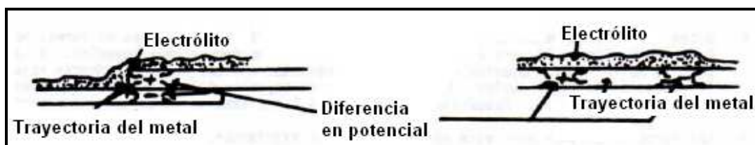
Figura 4.149. Acción Electrolítica. Fuente: Investigación documental. Tomado de: Manual de la IAAFA.
