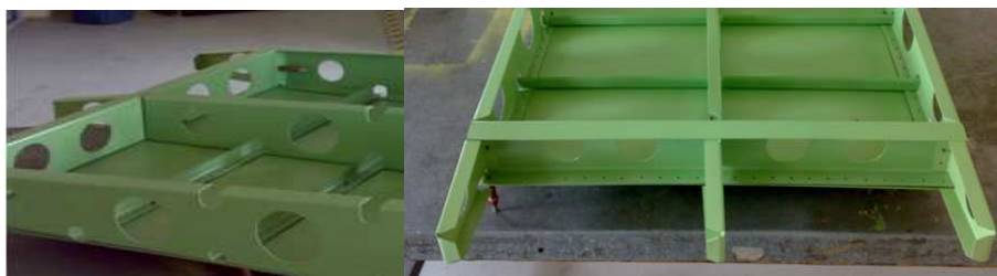
Figura 4.178. Costillas posteriores falsas sujetadas con clecos. Fuente: Investigación de campo. Editado por: Luis Calderón.
