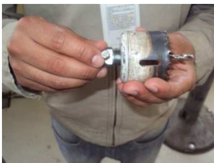
Figura 3.6. Insertado de la broca de campana en el conjunto (adaptador y broca guía). Fuente: Investigación de campo. Editado por: Luis Calderón.
