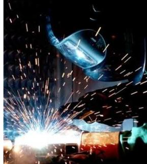
Fig. 2.1 Soldadura por arco eléctrico.
