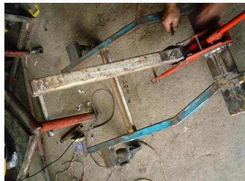
**FOTO #2: Construcción de la estructura o base del soporte móvil y posteriormente acoplado al gato hidráulico**
