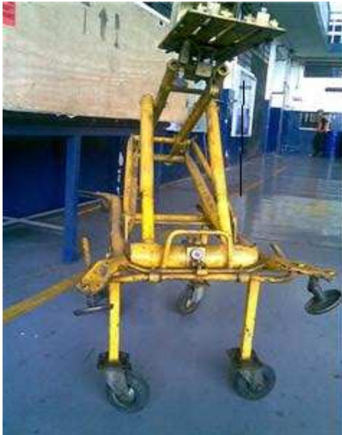
Fig. 3.2 Soporte utilizado para el montaje, desmontaje y traslado del CSD del motor JT-8D del Boeing 727-200.
