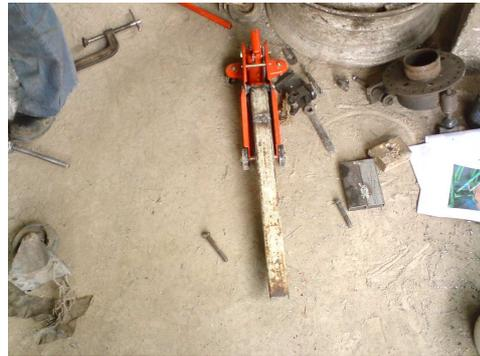
**FOTO #1: Construcción del brazo hidráulico y soldado del mismo al gato hidráulico.**
