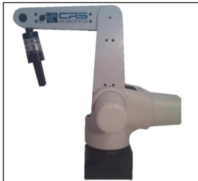
**Figura. 15** Articulaciones del manipulador robótico CRS A255.
