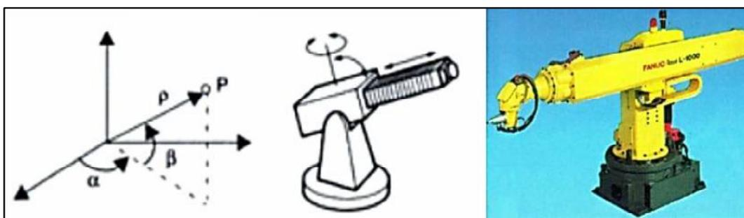
**Figura. 8** Robot polar o esférico.
