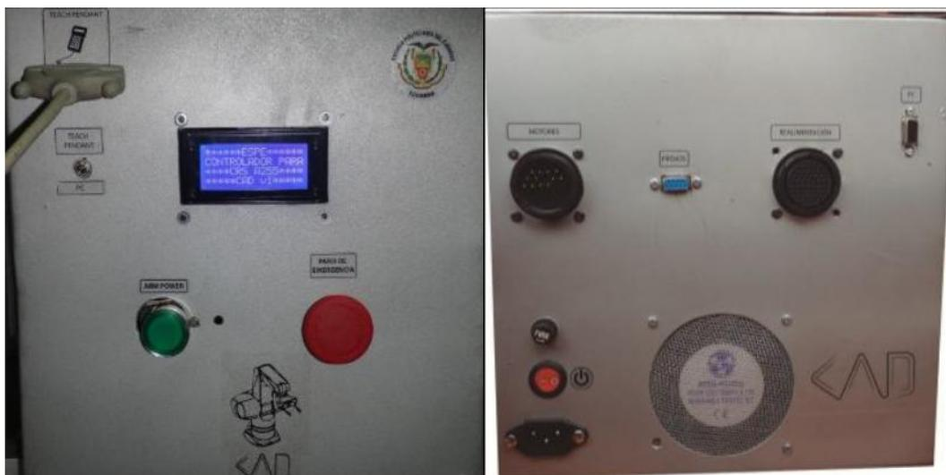
**Figura. 27** Panel frontal y panel posterior del chasis del controlador CAD.
