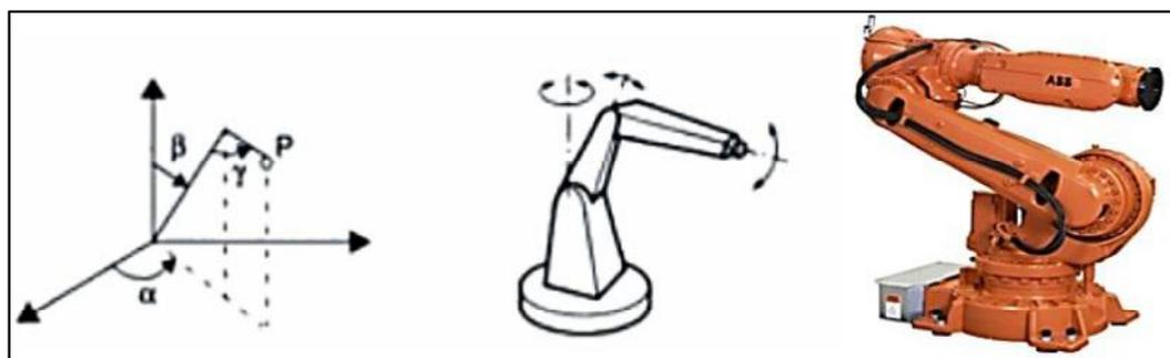
**Figura. 10** Robot Angular o Antropomórfico.
