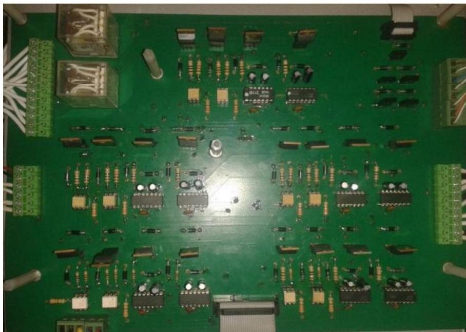
**Figura. 50** Acabado final de tarjeta de potencia CDC2.
