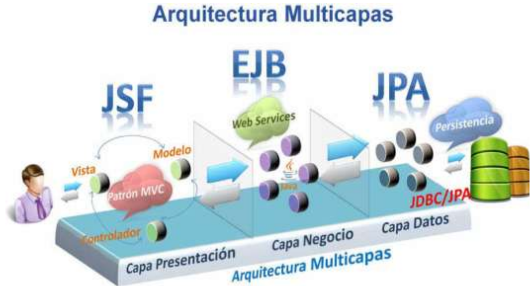
Ilustración 2: Arquitectura Multicapas con la capa de presentación JSF Fuente: (Mentoring, 2012).
