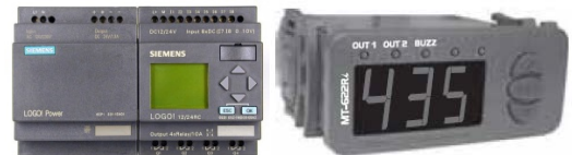
Figura 9 Controladores del horno. a) PLC Siemens LOGO!. b) Controlador Full Gauge MT-622.
