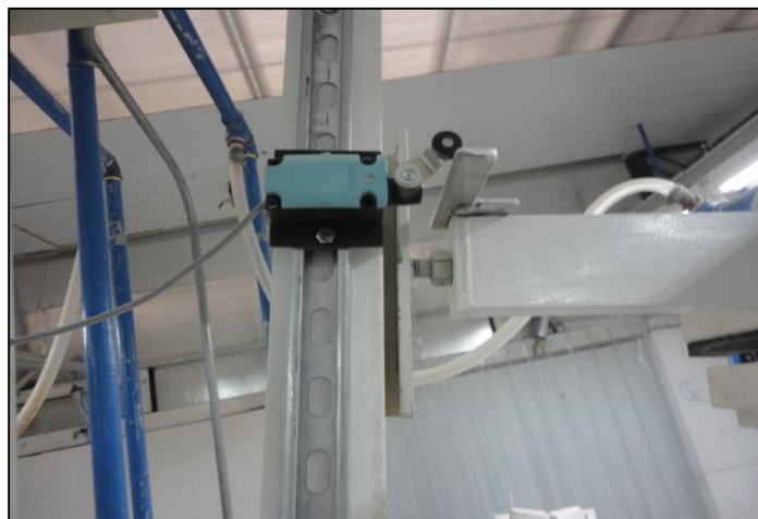
Figura 85 Ajuste y posicionamiento de fines de carrera.
