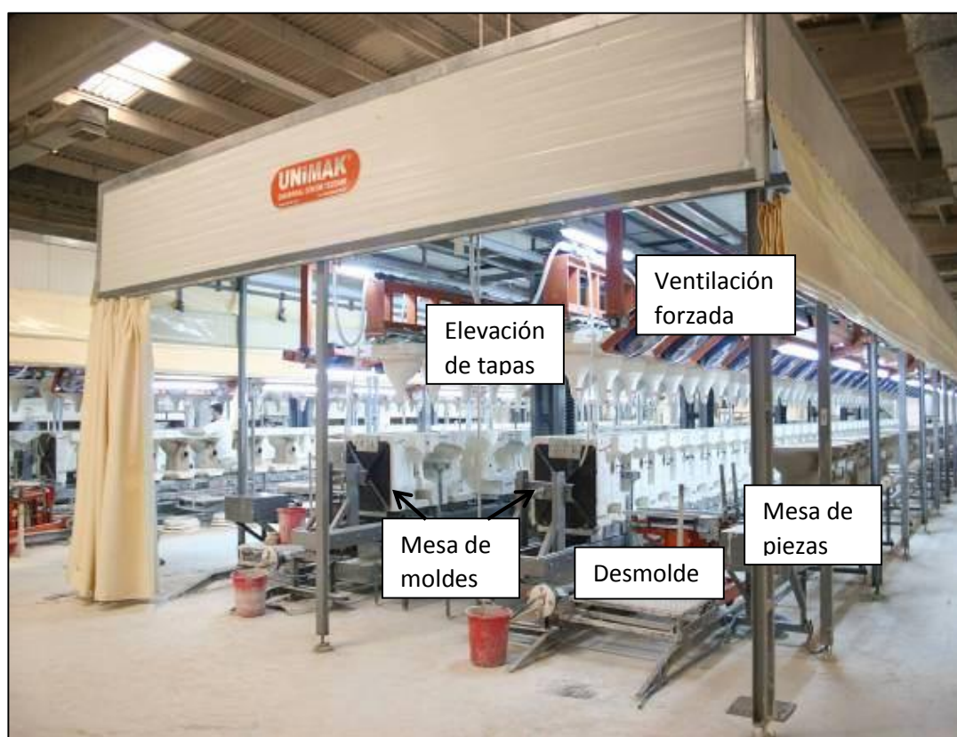
Figura 2. Partes Línea de Conformación cerámica.
