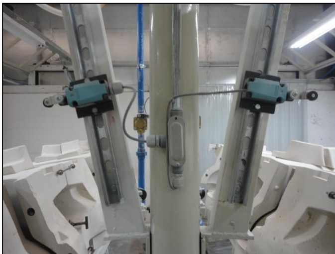
Figura 86 Ajuste de fines de carrera inferiores.
