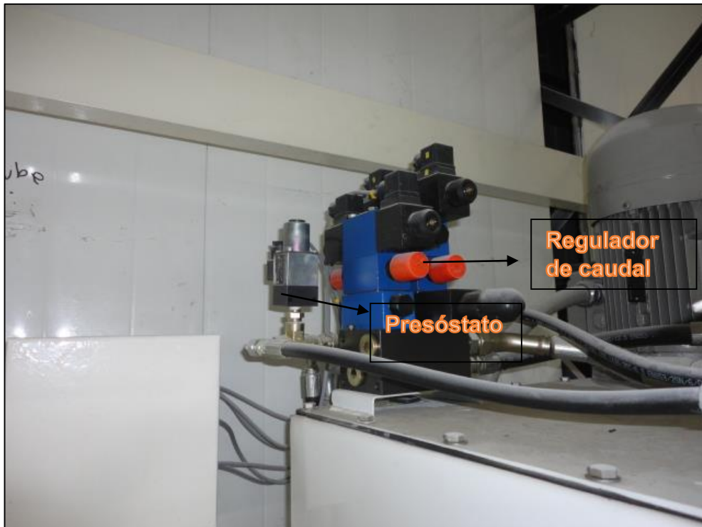
Figura 84 Ajuste en unidad hidráulica.
