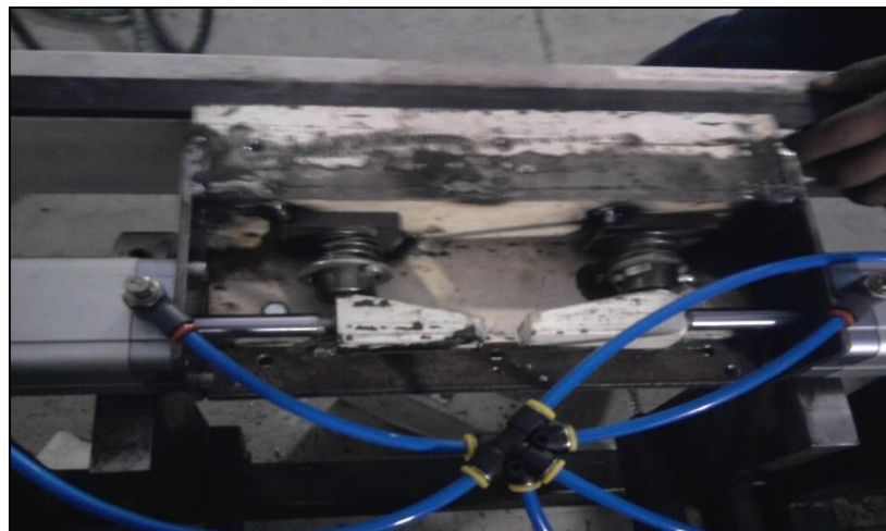
Figura 76 Pruebas sistema neumático de apriete.
