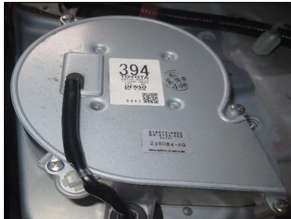
Figura 4. 20 Ventilador de la batería HV.
