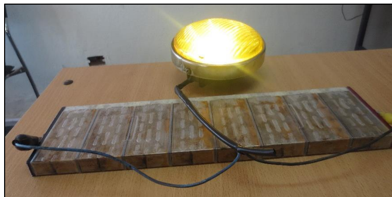
Figura 4. 34 Descarga de los módulos.
