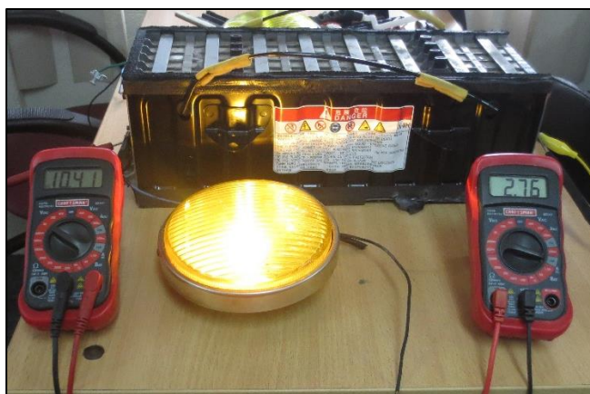
Figura 4. 29 Prueba con el foco de 12 V-55 Watt.
