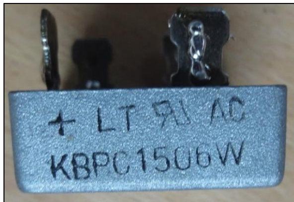
Figura 3. 5 Puente rectificador de 15 Amperios-600V.
