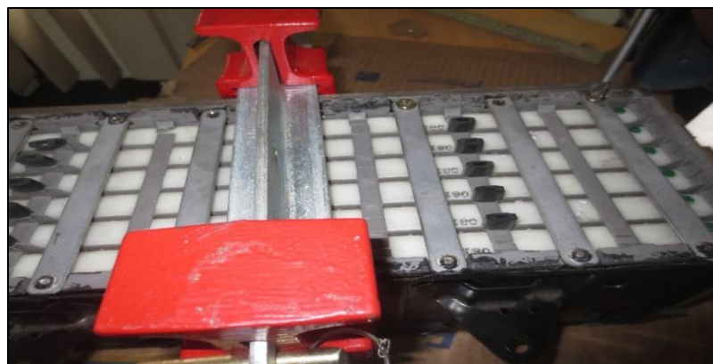
Figura 4. 36 Centrado de los módulos del bloque 3.
