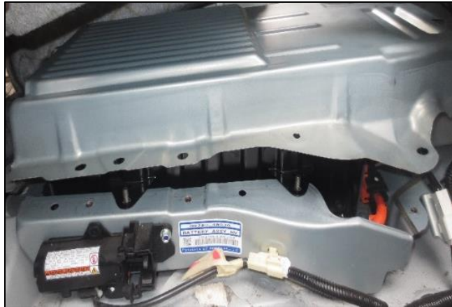
Figura 4. 19 Desmontaje de la cubierta de protección.
