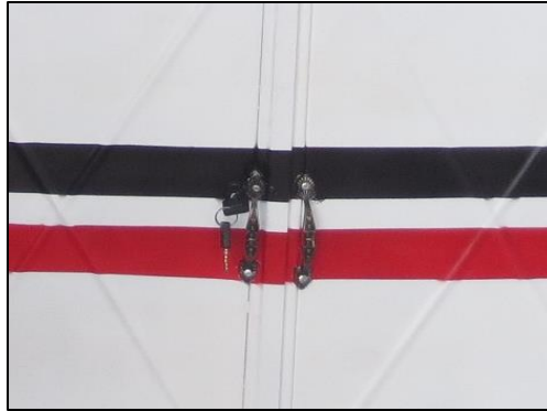
Figura 3. 24 Manijas, seguro y tope de las compuertas.
