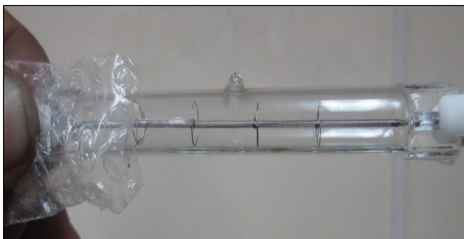
Figura 3. 6 Foco halógeno para descarga la batería HV.
