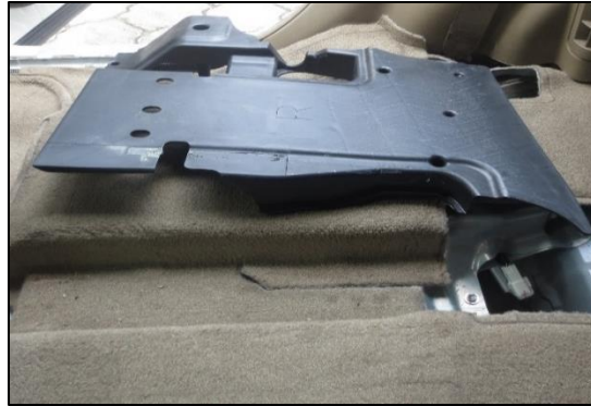
Figura 4. 15 Protectores de la batería HV
