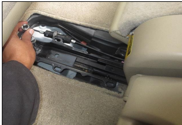
Figura 4. 14 Desmontaje de los asientos posteriores.
