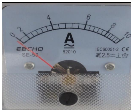
Figura 3. 4 Amperímetro analógico de medición carga y descarga. Fuente: Gómez, Hidalgo, Erazo.
