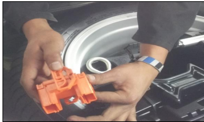
Figura 2. 3 Jumper de seguridad.
