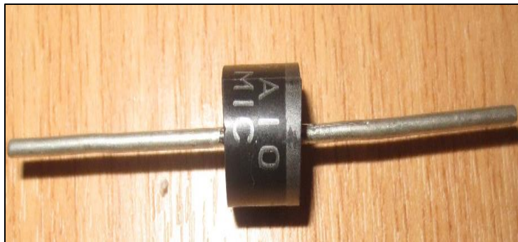
Figura 3. 9 Diodo protector del sistema de carga.
