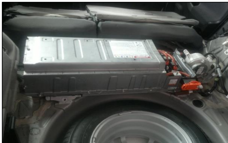
Figura 2. 2 Ubicación de la batería de alta tensión.
