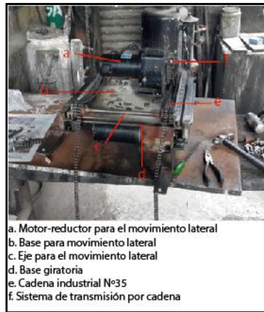
Figura 5. Asiento de potencia terminado.
