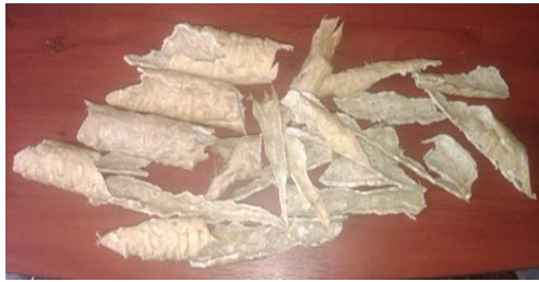
Figura 140 Tubos extruidos cortador a) primeras pruebas, b) prueba final con las correcciones respectivas
