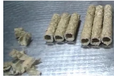
Figura 140 Tubos extruidos cortador a) primeras pruebas, b) prueba final con las correcciones respectivas
