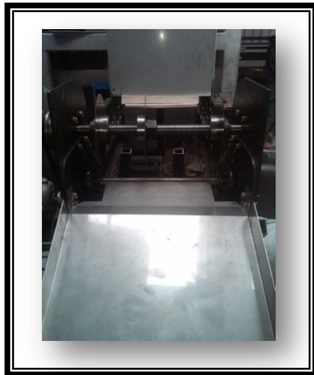
Figura 114 Construcción del Sistema de Salida: a) Bandejas de salida punzonadas b) Bandejas de salida de producto ensambladas c) Bandejas de Salida con una muestra
