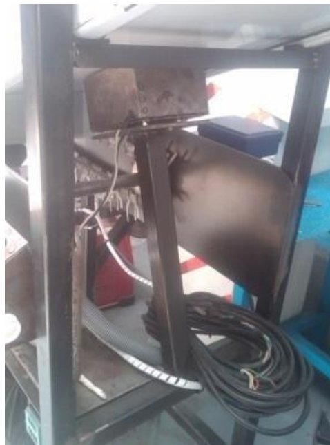
Figura 135 Vista real del vibrador con la tolva
