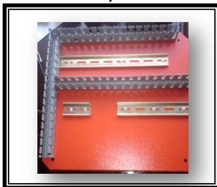
Figura 118 Construcción y armado de los Tableros Eléctricos: a) Caja del panel principal y el HMI b) Cableado del HMI c) Vista frontal del HMI d) Doble fondo del panel principal con riel DIN y canaleta agujereada e) Panel Principal cableado y armado.
