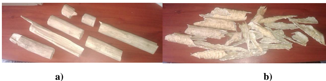
Figura 123 Pruebas realizadas a) madera, b) tubos extruidos a altas velocidades
