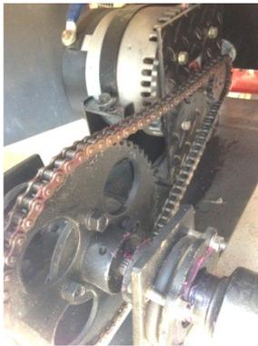
Figura 6. Bases del motor y transmisión
