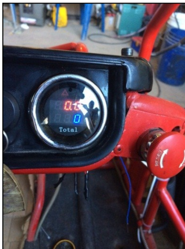
Figura 5.38: Supervisión del sistema de carga de baterías
