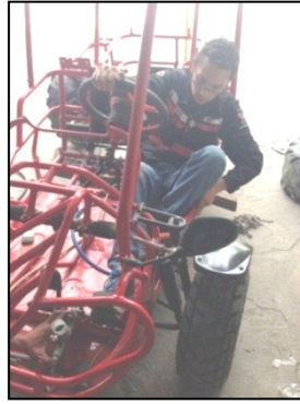
Figura 5.32: Purgado del sistema de frenos
