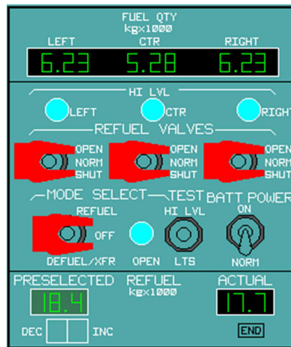
Fig. 2.50: Panel de control para carga y descarga de combustible. Fuente: VACBI –Manual de entrenamiento A320.
