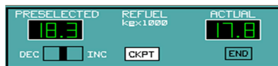
Fig. 2.94: Pre-selector cantidad de combustible. Fuente: VACBI –Manual de entrenamiento A320
