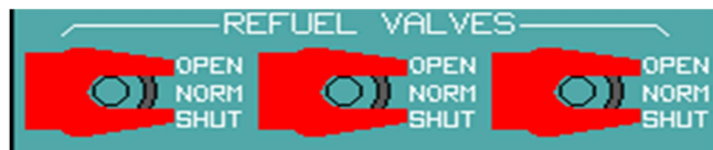
Fig. 2.53: Selectores de las válvulas de carga de combustible.
