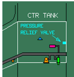
Fig. 2.49: Ubicación válvula de alivio de presión. Fuente: VACBI –Manual de entrenamiento A320
