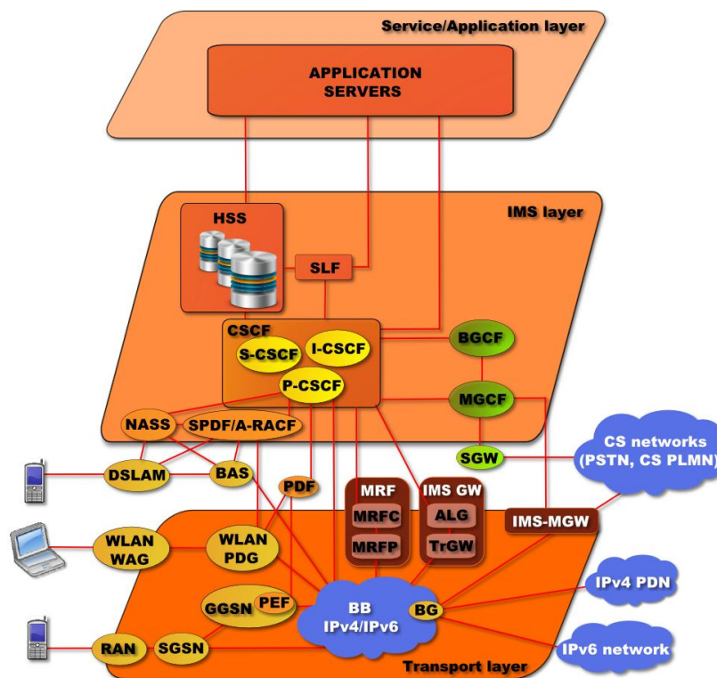
Figura 3.4 Estructura de la red IMS [16]
