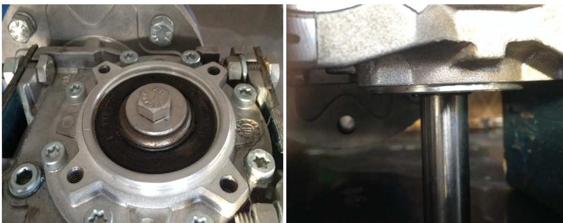
**Figura 5-10 Sujeción entre el eje del agitador y el motorreductor.**
