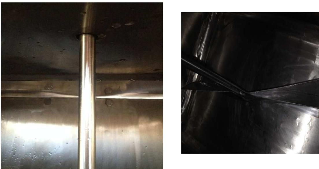
**Figura 5-9 Paleta del agitador.**
