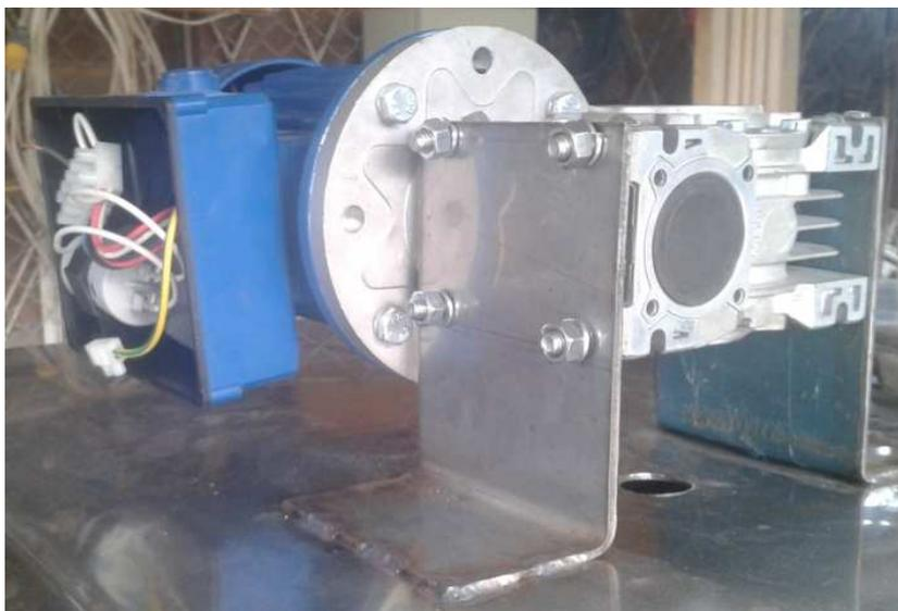
**Figura 5-8 Sujeción del motorreductor en el tanque de refrigeración.**
