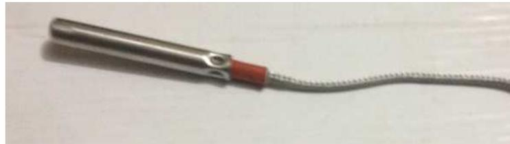
**Figura 2-9 Sensor de temperatura tipo termopar.**
