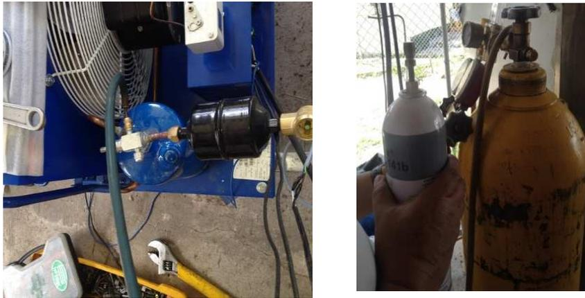
**Figura 5-21 Proceso de limpieza de humedad en el serpentín.**
