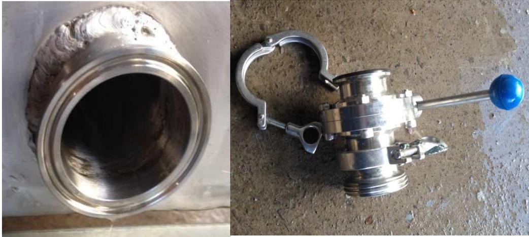
**Figura 5-6 Sujeción y acoples de la válvula de mariposa.**
