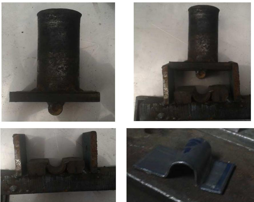
**Figura 5-3 Matriz del sujetador para el serpentín.**
