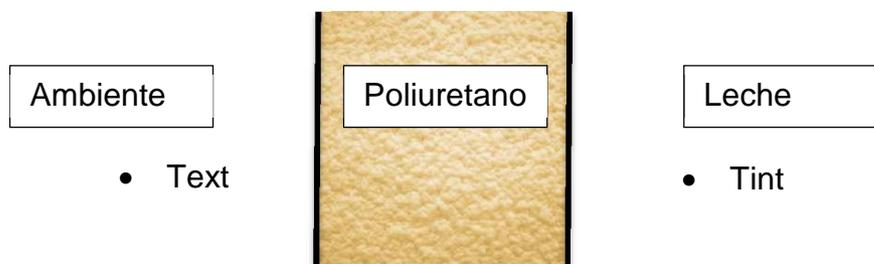
**Figura 4-2 Aislamiento térmico entre las paredes del tanque.**
