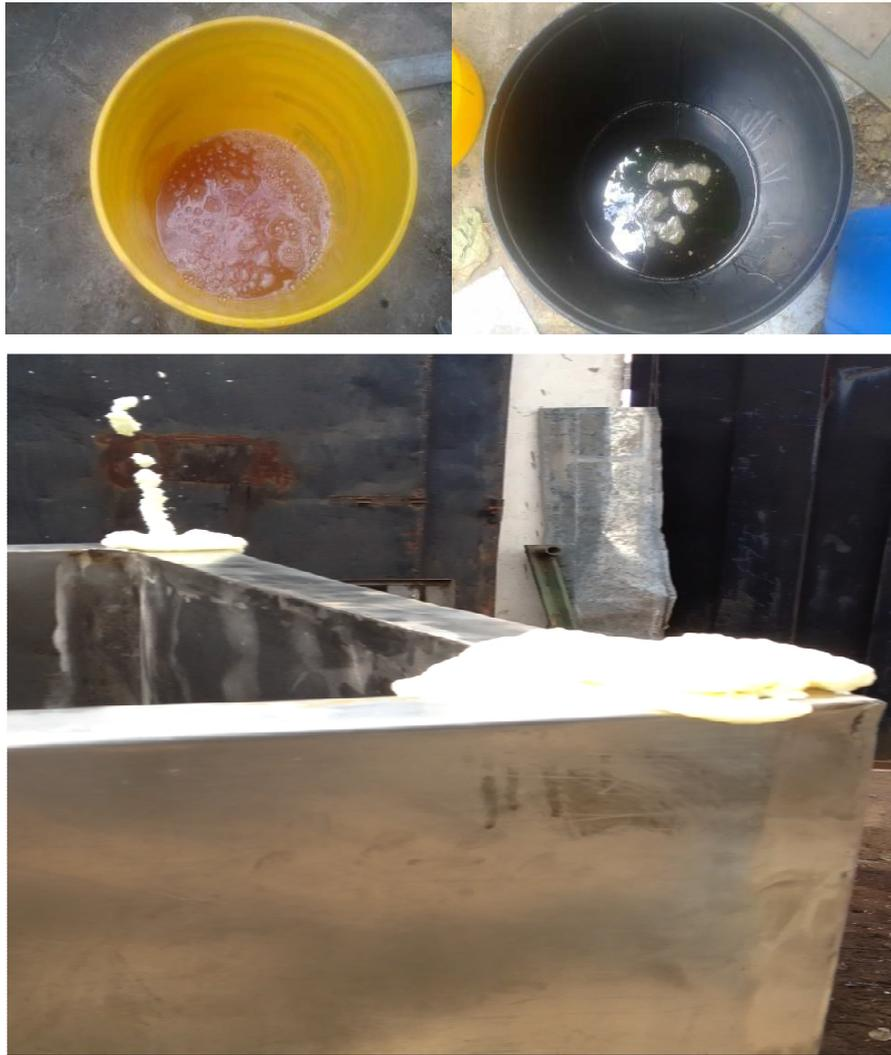
**Figura 5-5 Inyección de los componentes químicos.**
