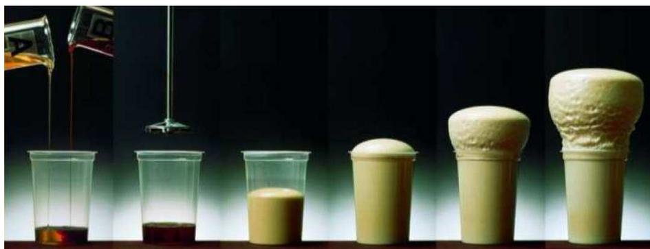
**Figura 2-4 Proceso de expansión de la espuma de poliuretano.**
