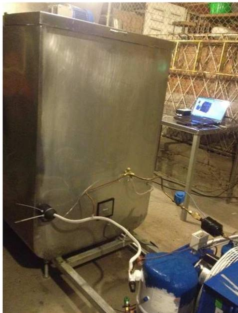
**Figura 5-1** Ensamble del sistema de refrigeración de leche.
