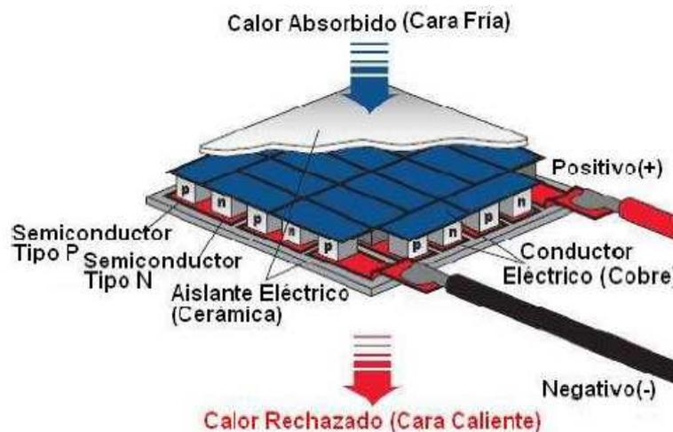
**Figura 3-7 Estructura interna de una celda peltier.**
