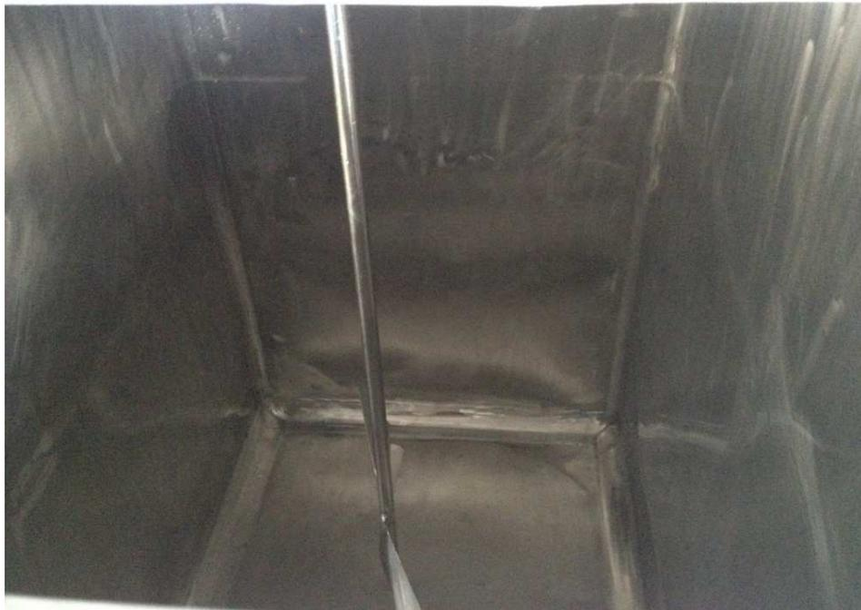
**Figura 5-2 Tapas internas del tanque de refrigeración.**
