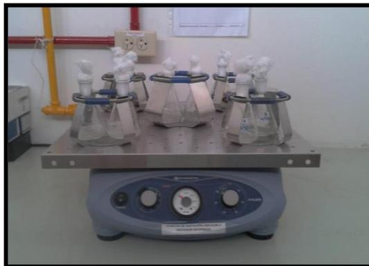
**Figura 8:** Fotografía del agitador rotatorio con matraces Erlenmeyer.
