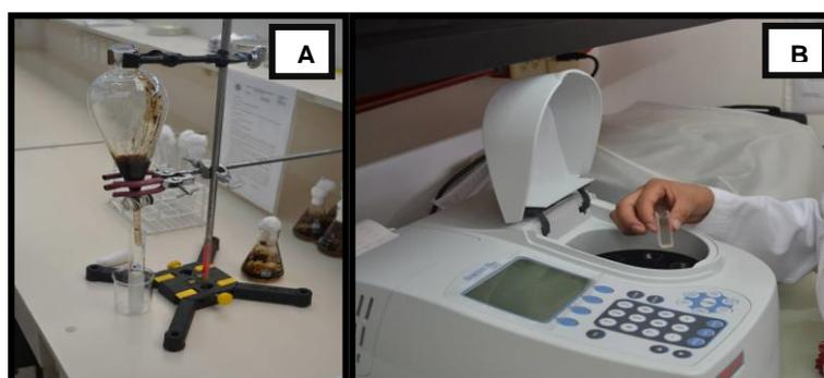
**Figura 11:** Fotografía. A) Separación del petróleo crudo del medio y la suspensión bacteriana. B) Espectrofotómetro.
