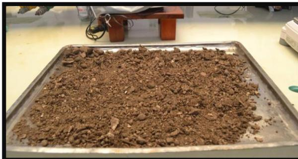
**Figura 4:** Fotografía de una muestra de suelo extendida en una bandeja, para ser sometida a secado, molienda y tamizado.
