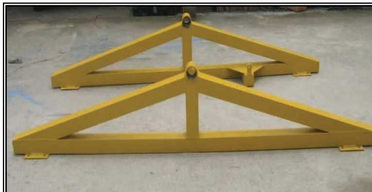
Figura 3.17 Bases laterales del soporte de la estructura simuladora terminados, vista lateral.
