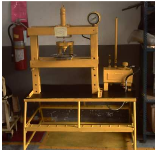
Figura 5.37: Prensa hidráulica armada y terminada.
