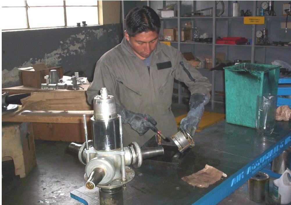
Figura 3.8. Limpieza de las abrazaderas, y conjunto de rodamientos.
