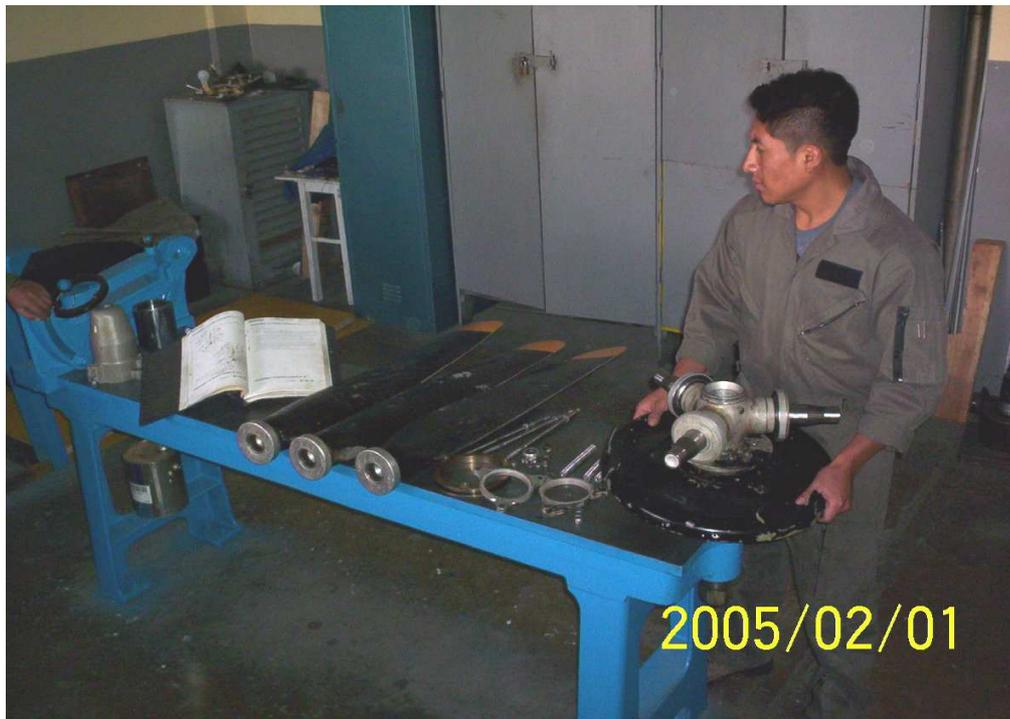
Figura 3.9. Hélice desarmada (exterior).
