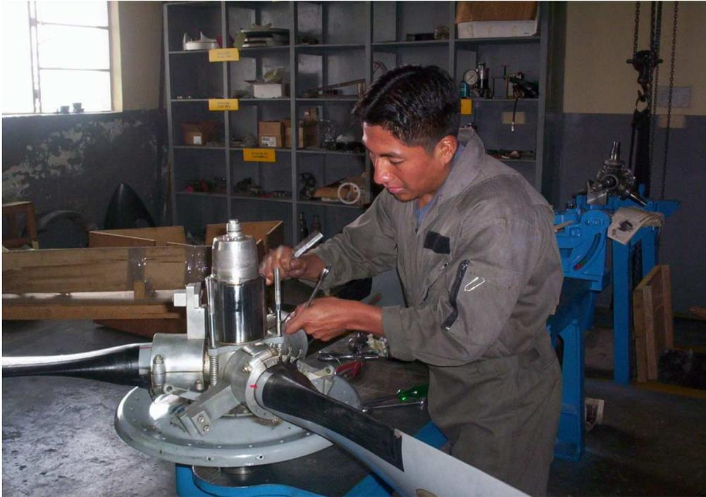
Figura 3.5. Desarmado de las contrapesas y abrazaderas.
