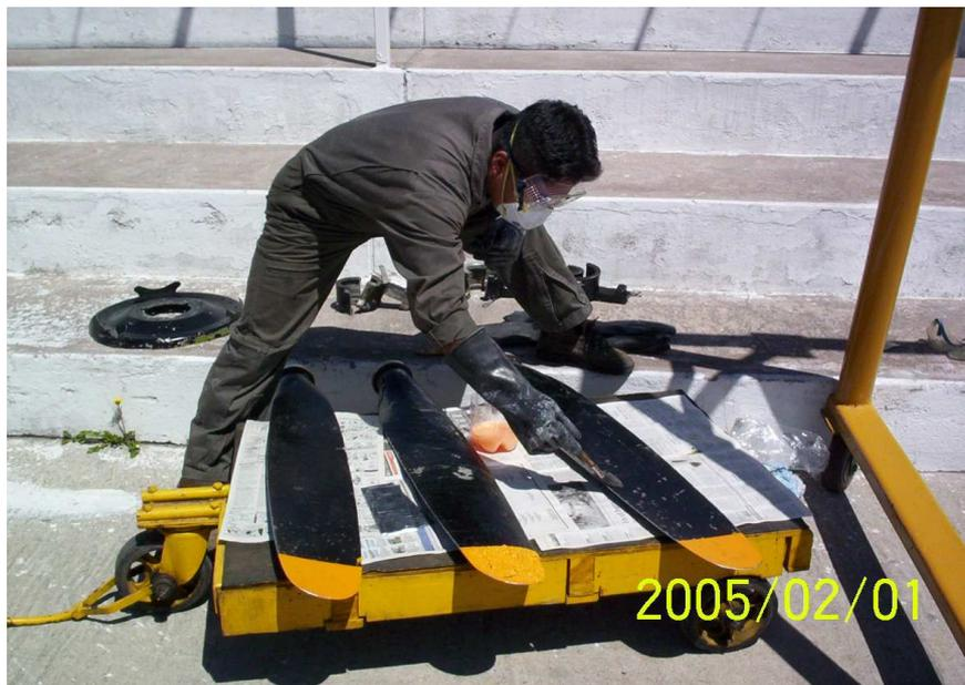
Figura 3.12. Aplicación del removedor.
