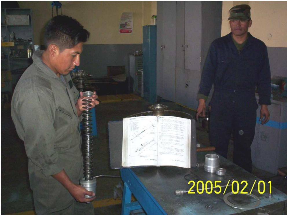
Figura 3.19. Armado de la seguridad posterior del Resorte.
