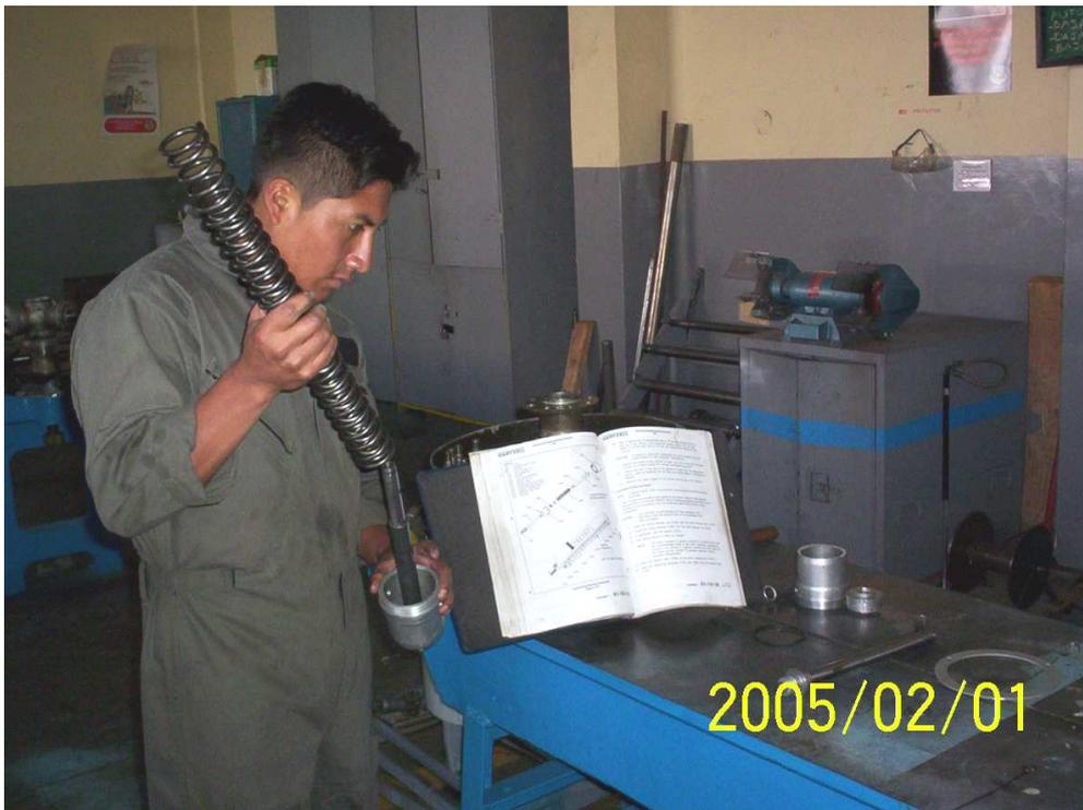
Figura 3.18. Armado de los dos resortes con el tubo de transferencia y capuchón.
