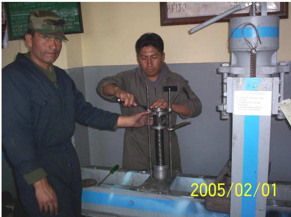
Figura 3.20. Resorte en la prensa para colocar el seguro hendido en la culata
