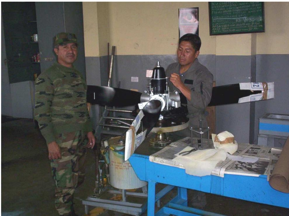
Figura 3.23. Comprobación de los Ángulos de las Palas
