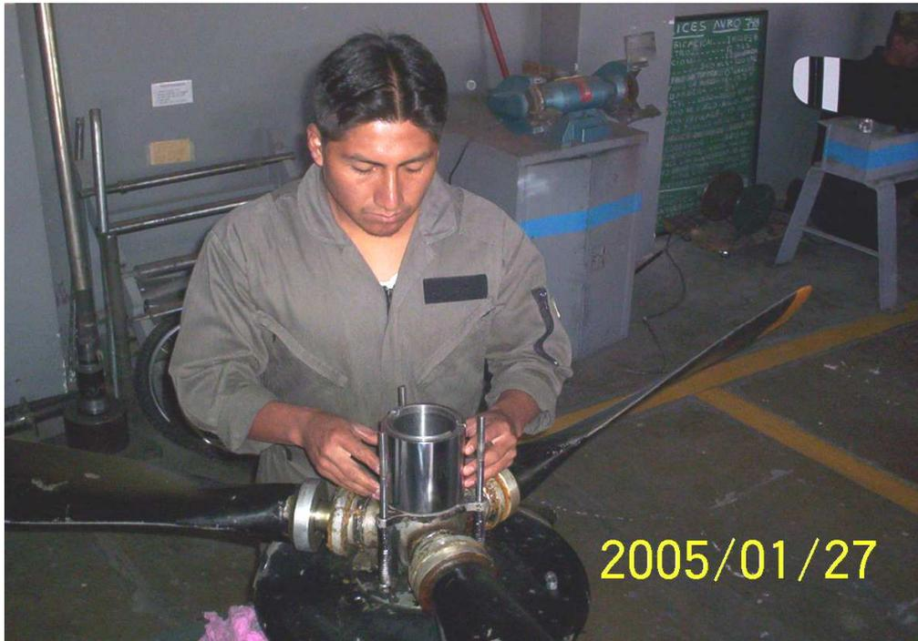
Figura 3.4. Desarmado del cilindro.
