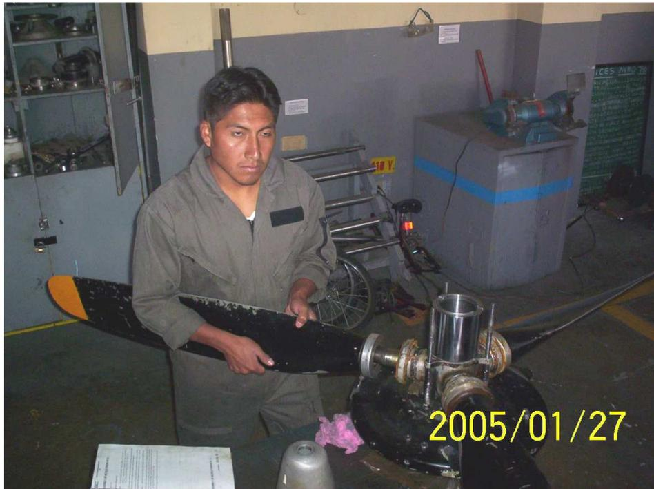
Figura 3.6. Desmontaje de Palas.
