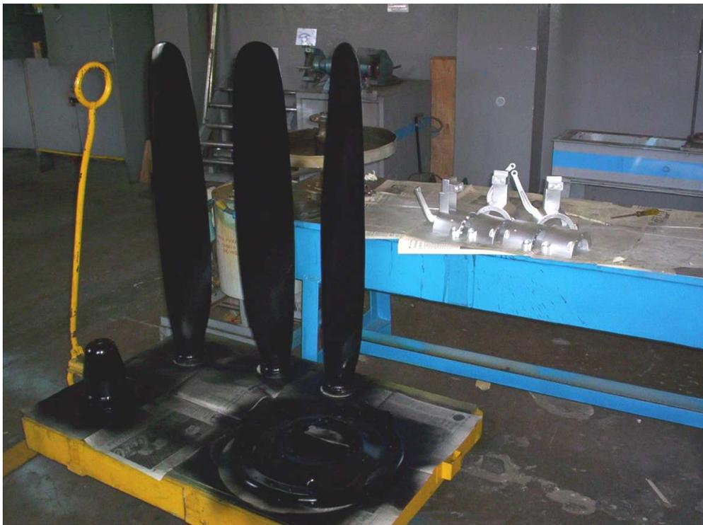
Figura 3.16. Pintado final de las palas, pistón, plato, y abrazaderas.
