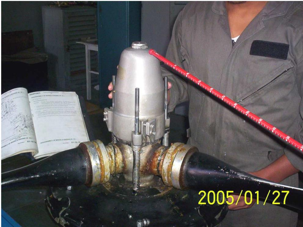
Figura 3.1. Desmontaje del pistón
