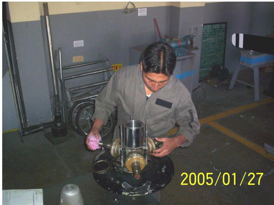
Figura 3.7. Desarmado del conjunto de rodamientos.
