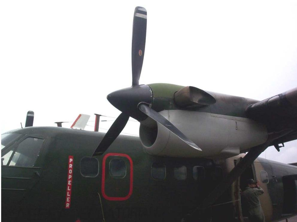
Figura 2.1. Hélice Hartzell HC-B3TN-3D del Avión Twin Otter.
